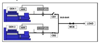
FIGURA 22. ALTERNADORES PARALELOS O DE SINCRONIZACIÓN
