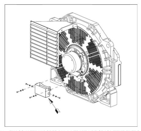
FIGURA 23. EN LOS ALTERNADORES P80, LA TRAMPA DE GRASA TIENE FILTRO DE AIRE.
