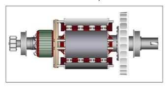
FIGURA 16. ROTOR DEL ALTERNADOR DE DOS COJINETES QUE MUESTRA UN EJE CON CHAVETERO PARA EL ACOPLAMIENTO FLEXIBLE (A LA DERECHA)
