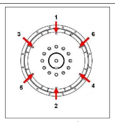
FIGURA 18. SECUENCIA DE FIJACIÓN AL VOLANTE
