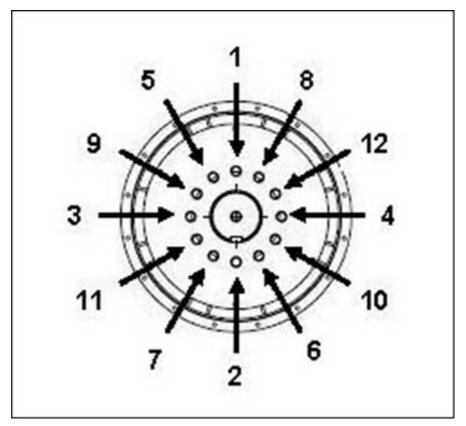
FIGURA 17. SECUENCIA DE FIJACIÓN AL CUBO
