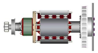
FIGURA 15. ROTOR DE ALTERNADOR DE UN COJINETE EN EL QUE SE MUESTRAN LOS DISCOS DE ACOPLAMIENTO ATORNILLADOS AL CUBO DEL ACOPLAMIENTO DEL EXTREMO IMPULSOR (A LA DERECHA)
