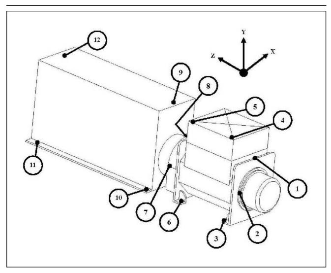
FIGURA 12. POSICIONES DE MEDICIÓN DE LA VIBRACIÓN
