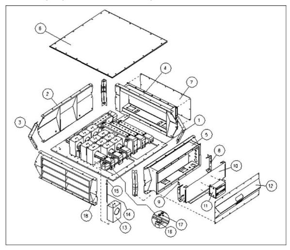
FIGURA 27. CAJA DE BORNES DE LV
