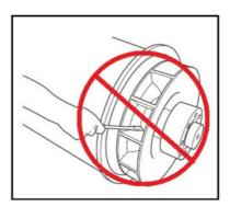
FIGURA 14. NO ROTAR CON UNA PALANCA
