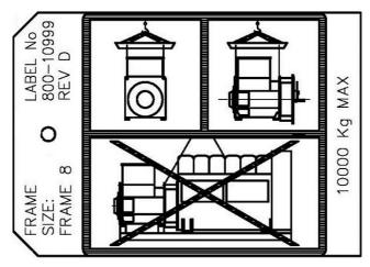
FIGURA 13. ETIQUETA DE ELEVACIÓN
