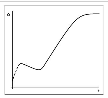
FIGURA 25. GRÁFICO DE LA RESISTENCIA DEL AISLAMIENTO
