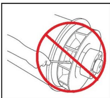
Des opérations efficaces et une longue durée de vie des composants dépendent de la minimisation du stress appliqué sur la mécanique de l'alternateur. Si couplé au sein d'un groupe électrogène, des interactions de dés-alignements et de vibrations avec le moteur de motrice peuvent engendrer une pression mécanique.
