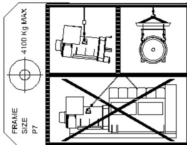
FIGURE 4. ÉTIQUETTE DE LEVAGE
