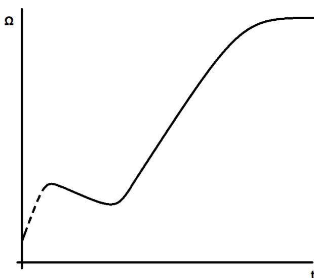
Une courbe type montre une augmentation initiale de la résistance, une chute puis une augmentation graduelle vers un niveau constant. Si le bobinage est seulement légèrement amorti, la section en pointillés de la courbe peut ne pas se produire. Continuer le séchage encore pendant une heure une fois le niveau constant atteint.
