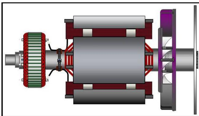
FIGURA 9. ROTORE DELL'ALTERNATORE MONOCUSCINETTO CON DISCHI DI ACCOPPIAMENTO AVVITATI AL MOZZO DI ACCOPPIAMENTO LATO COMANDO (A DESTRA)
