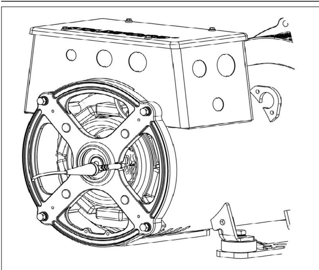
**FIGURA 14. RIMOZIONE DELLA SALDATURA DIODO**
