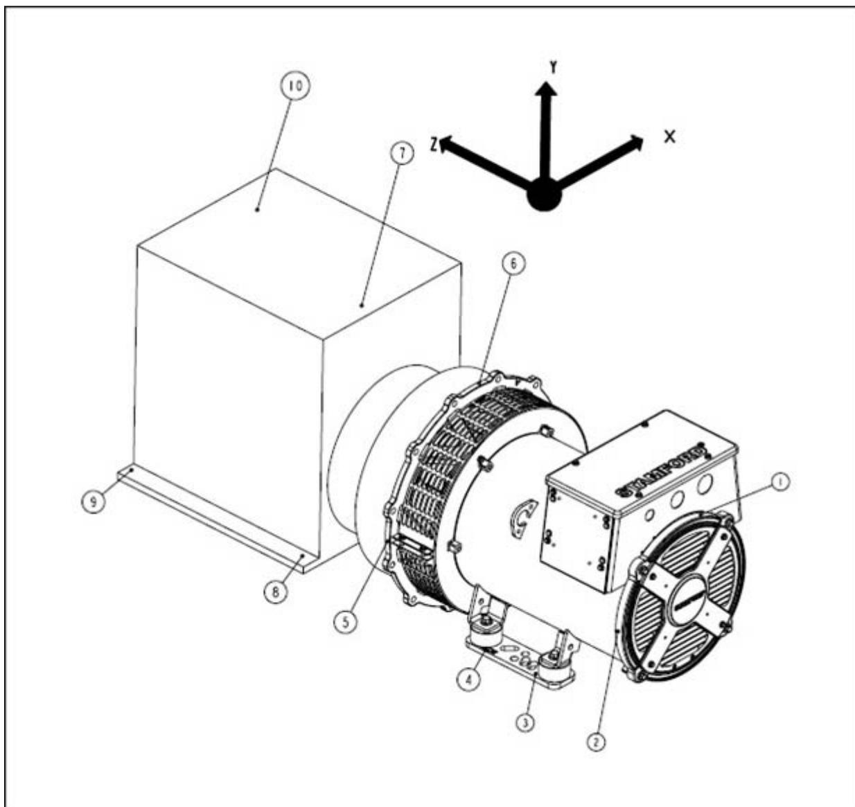
FIGURA 6. PUNTI DI MISURAZIONE DELLE VIBRAZIONI
