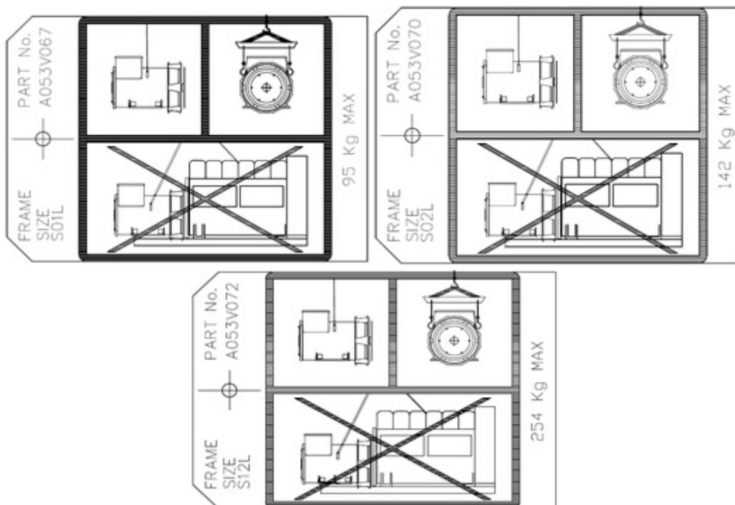
FIGURA 7. ETICHETTE CON CONFIGURAZIONE DI SOLLEVAMENTO
