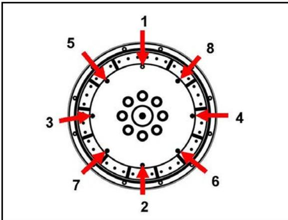
10. Aperte os parafusos para fixar o disco de acoplamento no volante do motor, pela sequência indicada acima.
