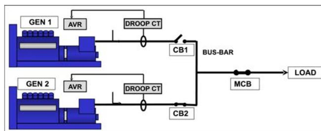
**FIGURA 7. COLOCAÇÃO EM PARALELO OU SINCRONIZAÇÃO DE ALTERNADORES**
