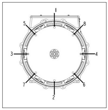
FIGURE 22. FIXING SEQUENCE TO FLYWHEEL
