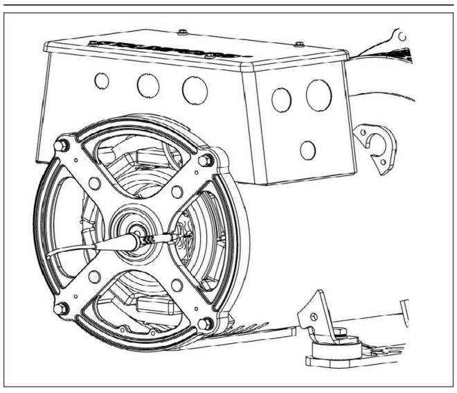
FIGURE 25. REMOVAL OF DIODE SOLDER
