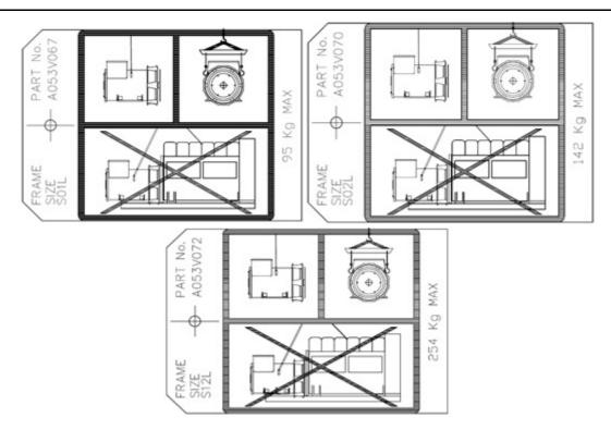
FIGURE 18. LIFTING LABELS
