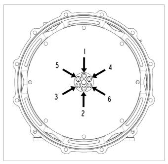
FIGURE 21. FIXING SEQUENCE TO HUB
