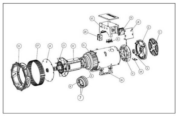
FIGURE 27. S0/S1 SINGLE BEARING ALTERNATOR
