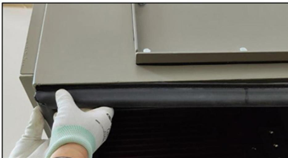
图 6. 安装后的垫片
