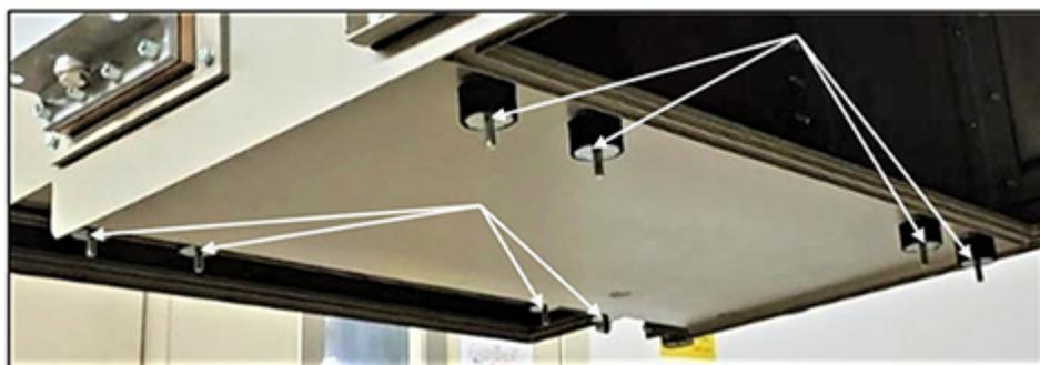
图 4. 将 8 个防振支架连同 6 毫米垫圈安装到水冷却器的下面。
