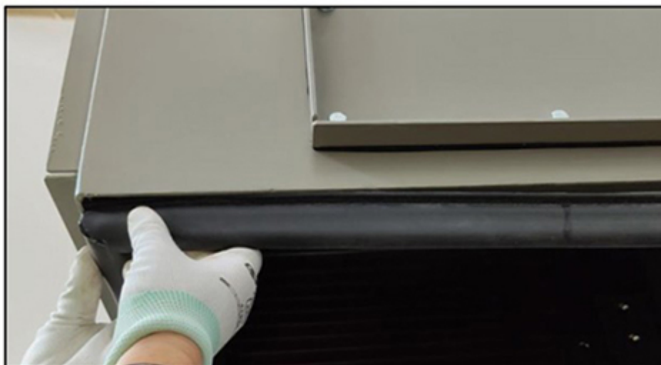
RYSUNEK 6. ZAMONTOWANA USZCZELKA
