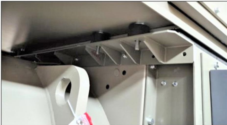
FIGUR 7. VATTENKYLAREN ÄR NEDSÄNKT PÅ PLATS
