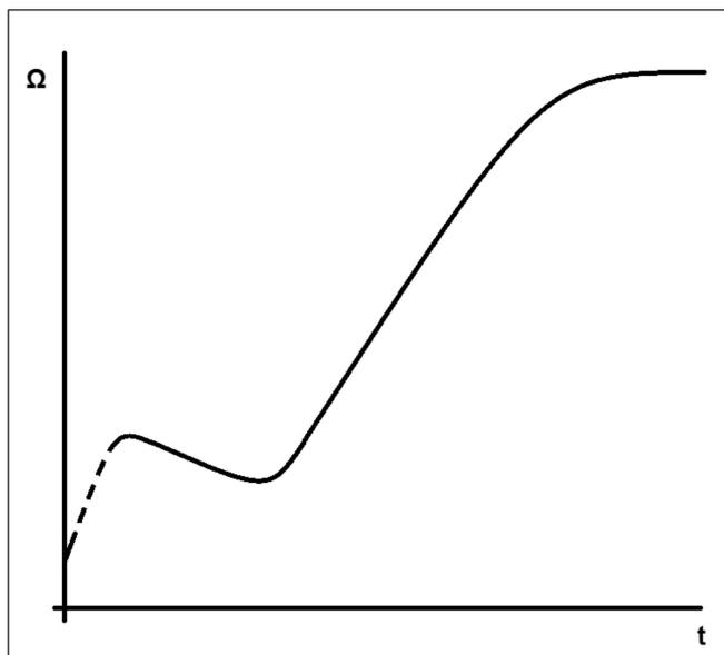
FIGURA 27. GRAFICO RESISTENZA DI ISOLAMENTO
