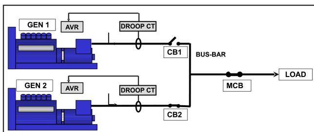
FIGURA 25. ALTERNATORI IN PARALLELO O A SINCRONIZZAZIONE
