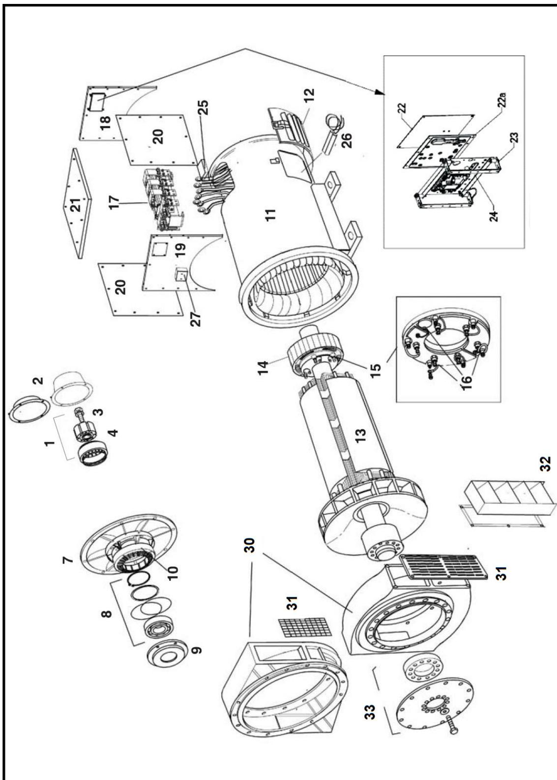
FIGURA 28. ALTERNATORE S5 MONOCUSCINETTO
