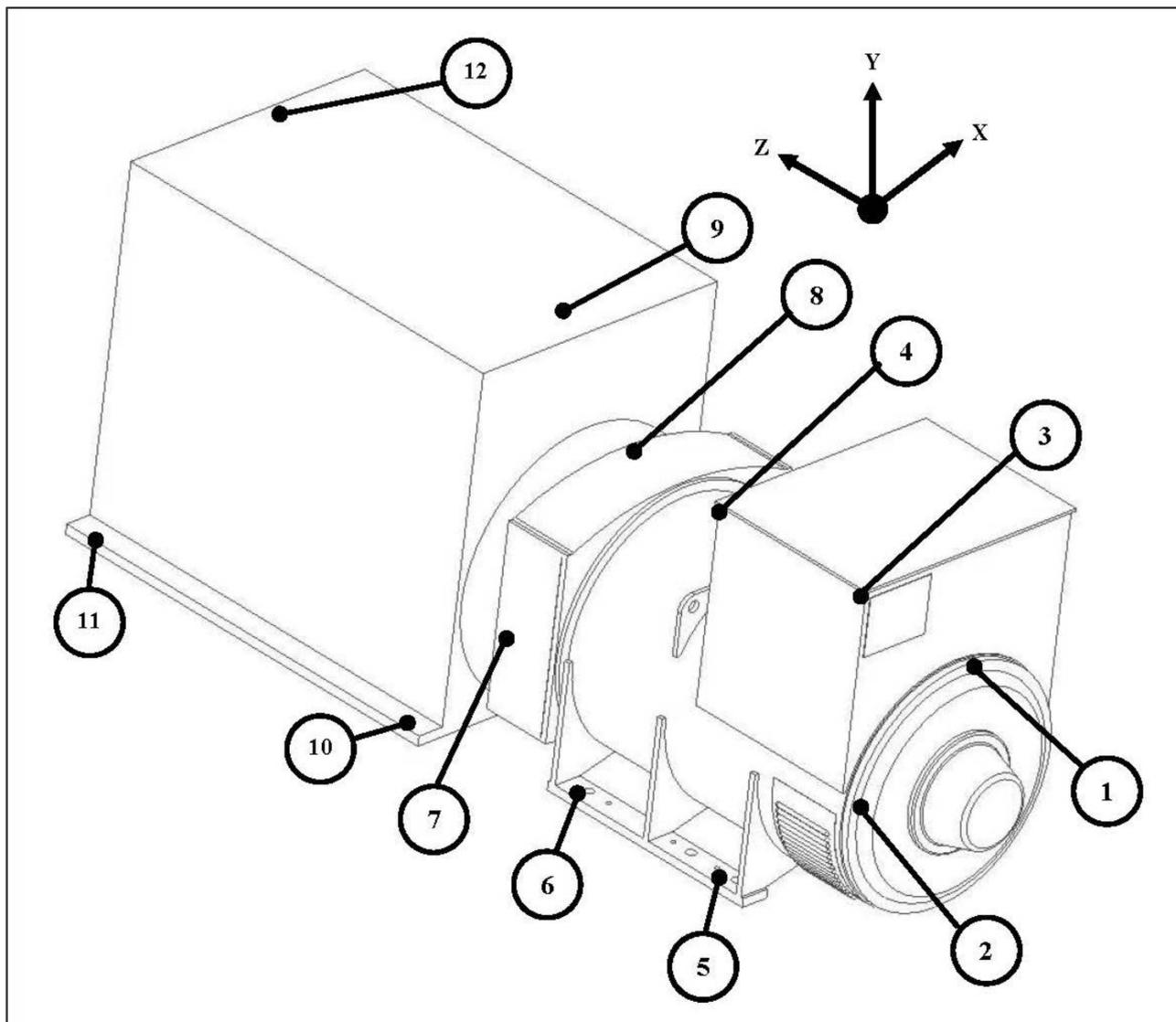
FIGURA 17. PUNTI DI MISURAZIONE DELLE VIBRAZIONI
