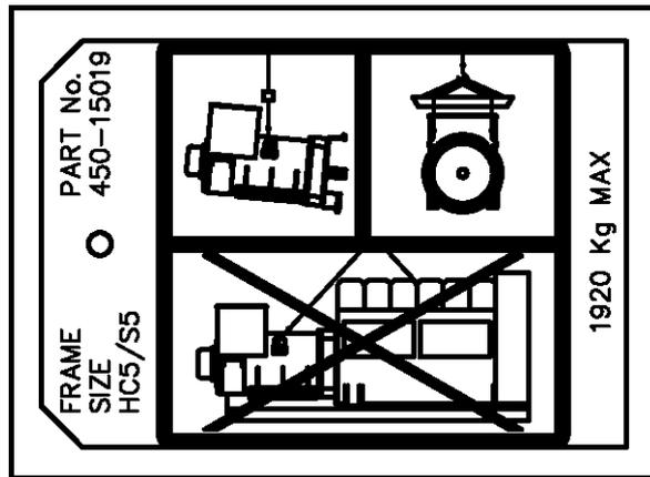
FIGURA 18. ETICHETTA CON CONFIGURAZIONE DI SOLLEVAMENTO
