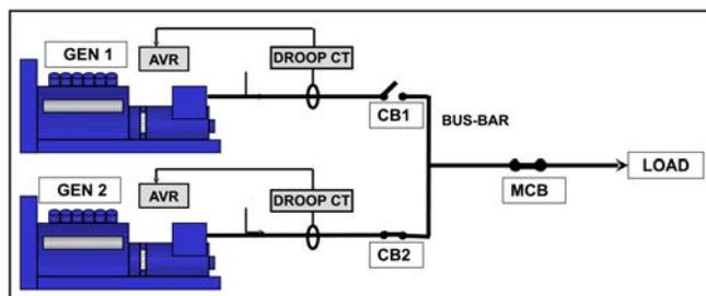
**FIGURA 26. ALTERNATORI IN PARALLELO O A SINCRONIZZAZIONE**
