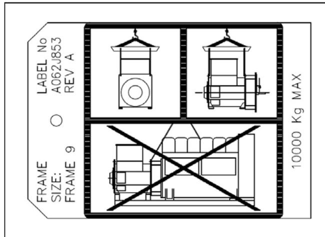
FIGURA 18. ETICHETTA CON CONFIGURAZIONE DI SOLLEVAMENTO
