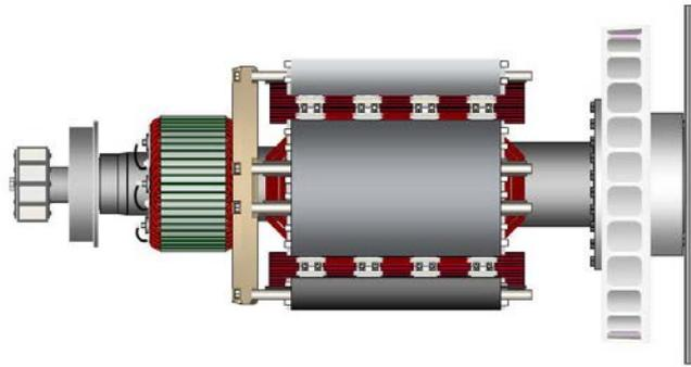
**FIGURA 20. ROTORE DELL'ALTERNATORE MONOCUSCINETTO CON DISCHI DI ACCOPIAMENTO AVVITATI AL MOZZO DI ACCOPIAMENTO LATO COMANDO (A DESTRA)**
