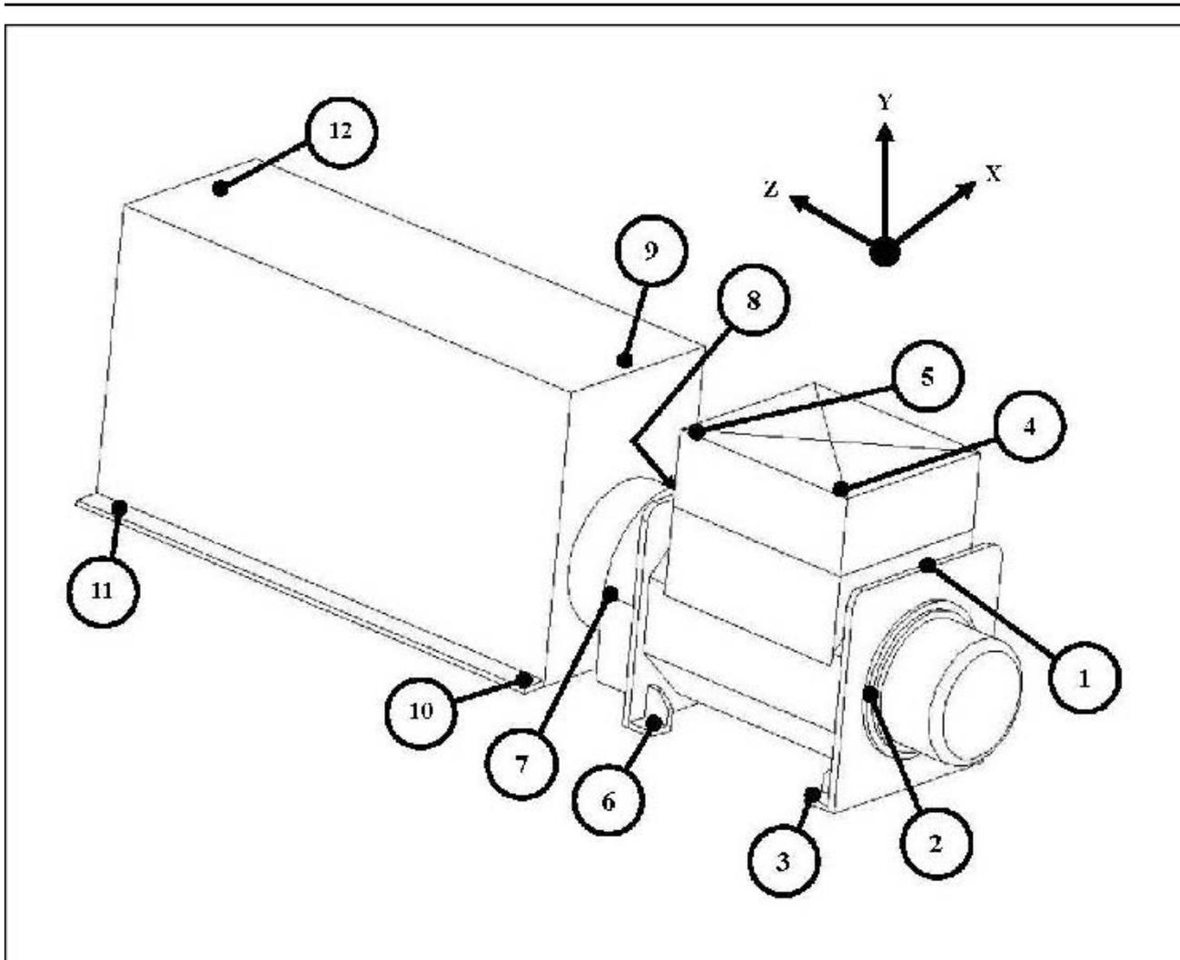
FIGURA 17. PUNTI DI MISURAZIONE DELLE VIBRAZIONI
