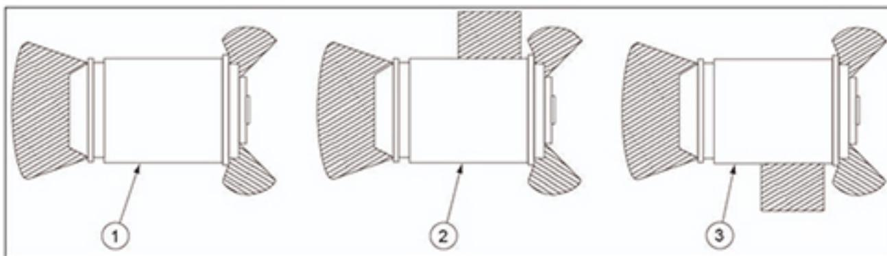
**FIGURA 5. ZONE DI PERICOLO DELL'ALTERNATORE S9**
