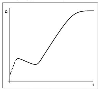
FIGURE 25. INSULATION RESISTANCE GRAPH
