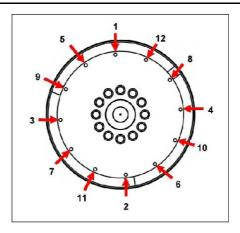
FIGURE 22. FIXING SEQUENCE
