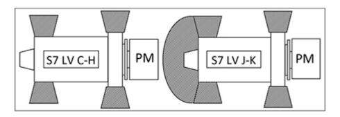
FIGURE 5. S7 LV ALTERNATOR HAZARD ZONES
