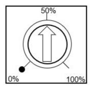
FIGURE 27. AVR [STAB] CONTROL POTENTIOMETER 50%
