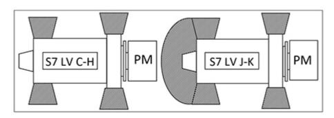
FIGURE 5. S7 LV ALTERNATOR HAZARD ZONES
