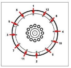
FIGURE 22. FIXING SEQUENCE
