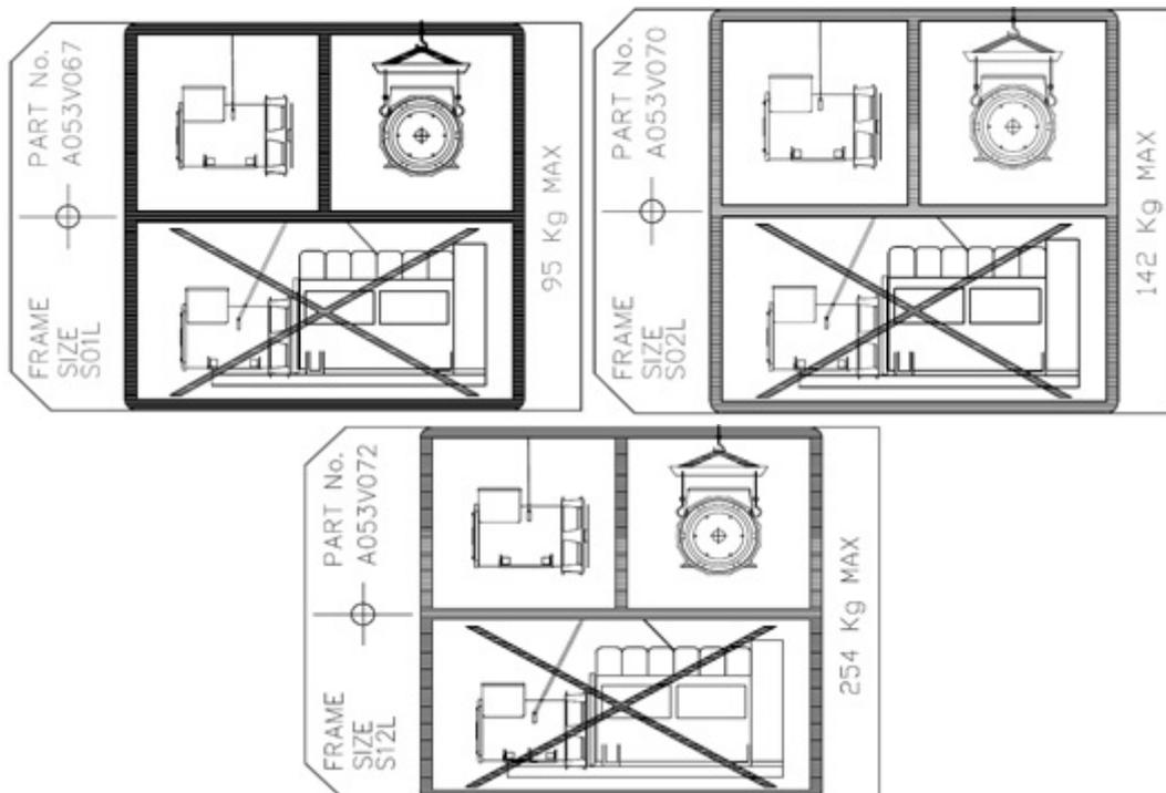
FIGURE 17. ÉTIQUETTE DE LEVAGE
