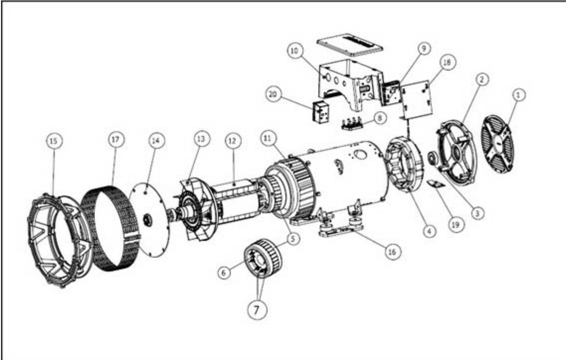
ABBILDUNG 27. GENERATOREN S0 UND S1 MIT EINEM LAGER
