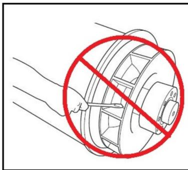
**ABBILDUNG 19. NICHT MIT EINER STANGE ALS HEBEL DREHEN.**
