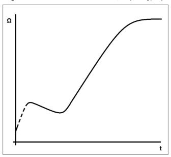
FIGURA 26. GRAFICO RESISTENZA DI ISOLAMENTO
