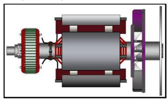
FIGURA 20. ROTORE DELL'ALTERNATORE MONOCUSCINETTO CON DISCHI DI ACCOPPIAMENTO AVVITATI AL MOZZO DI ACCOPPIAMENTO LATO COMANDO (A DESTRA)
