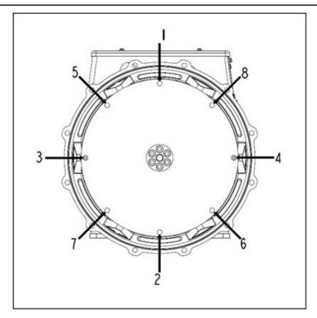
FIGURA 22. SEQUENZA DI FISSAGGIO AL VOLANO
