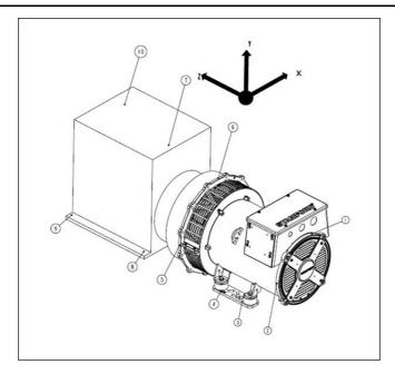
FIGURA 18. PUNTI DI MISURAZIONE DELLE VIBRAZIONI
