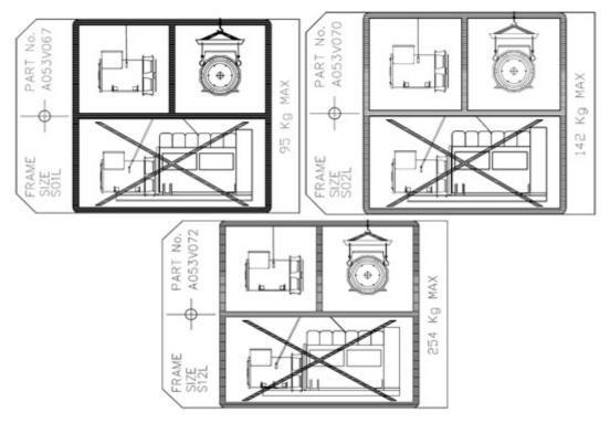
FIGURA 17. ETICHETTE CON CONFIGURAZIONE DI SOLLEVAMENTO
