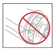
FIGURA 19. NON PORRE IN ROTAZIONE MEDIANTE LEVA
