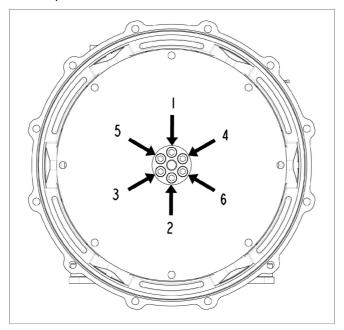
FIGURA 21. SEQUENZA DI FISSAGGIO AL MOZZO
