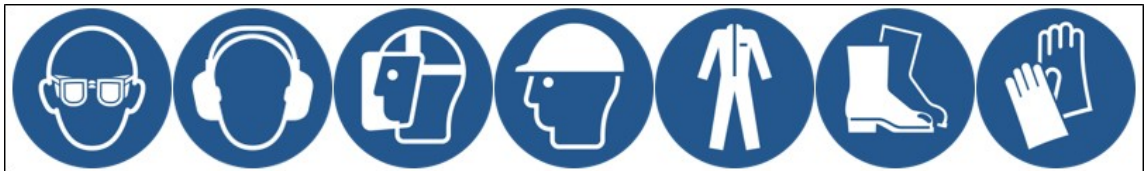
FIGURE 1. ÉQUIPEMENT DE PROTECTION PERSONNELLE (PPE) MINIMUM RECOMMANDÉ
