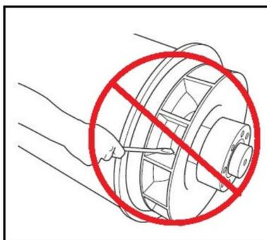
ABBILDUNG 24. DEN GENERATORROTOR NICHT MIT EINEM HEBEL DREHEN
