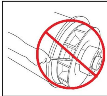
**ABBILDUNG 15. NICHT MIT EINEN HEBEL DREHEN**
