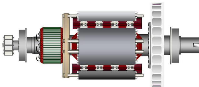
**ABBILDUNG 17. LÄUFER EINES ZWEILAGER-WECHSELSTROMGENERATORS, WELLE MIT PASSFEDERNUT FÜR ELASTISCHE KUPPLUNG (RECHTS)**
