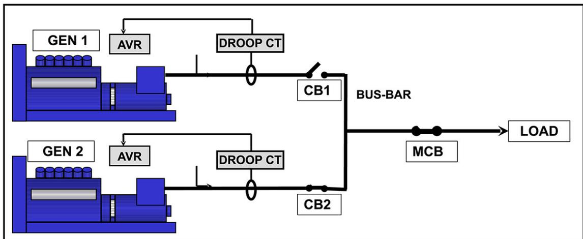
ABBILDUNG 22. PARALLELSCHALTEN BZW. SYNCHRONISIEREN VON WECHSELSTROMGENERATOREN
