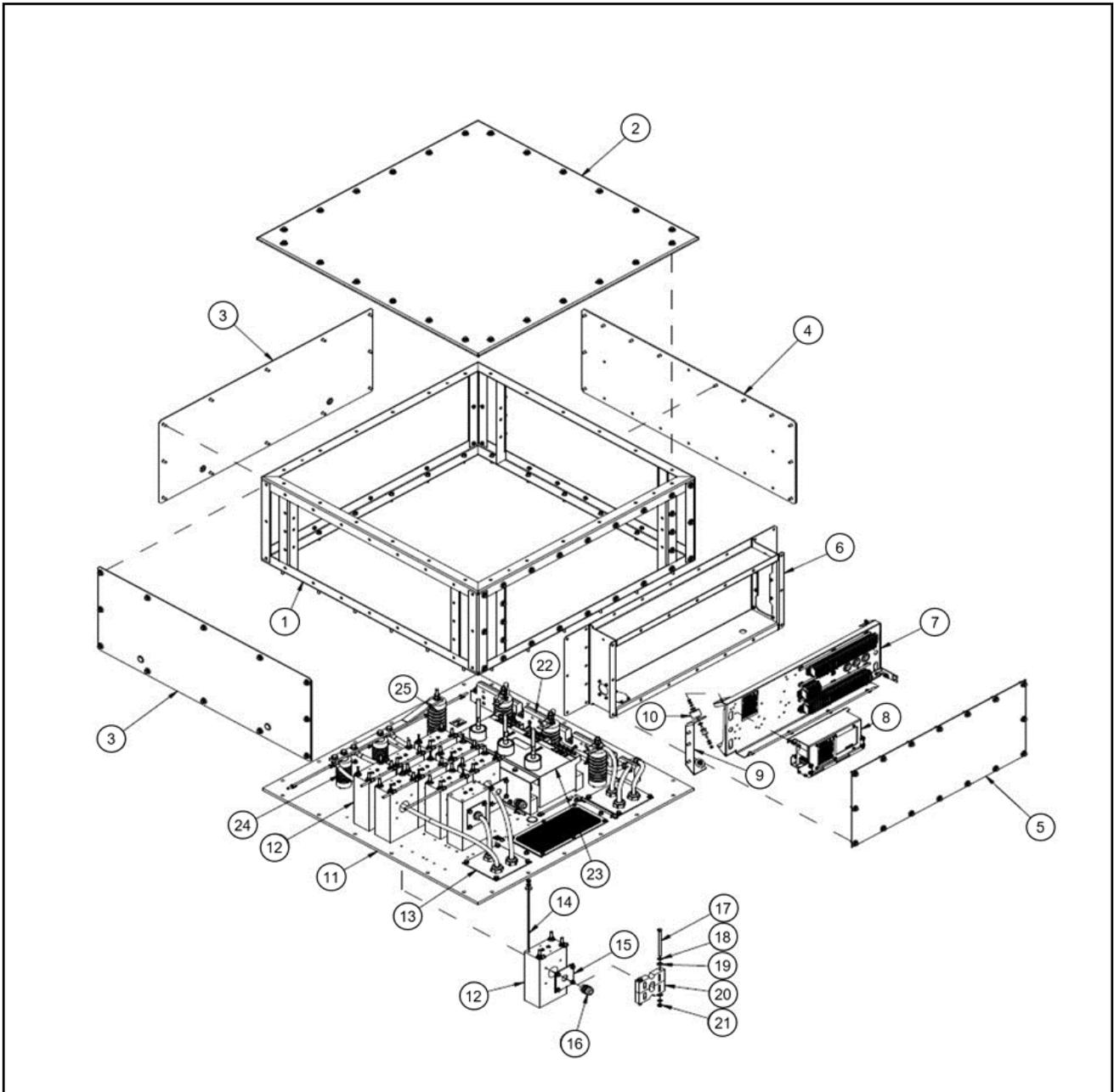
ABBILDUNG 28. TEILE UND BEFESTIGUNGSELEMENTE FÜR DEN MITTEL- UND HOCHSPANNUNGS-ANSCHLUSSKASTEN
