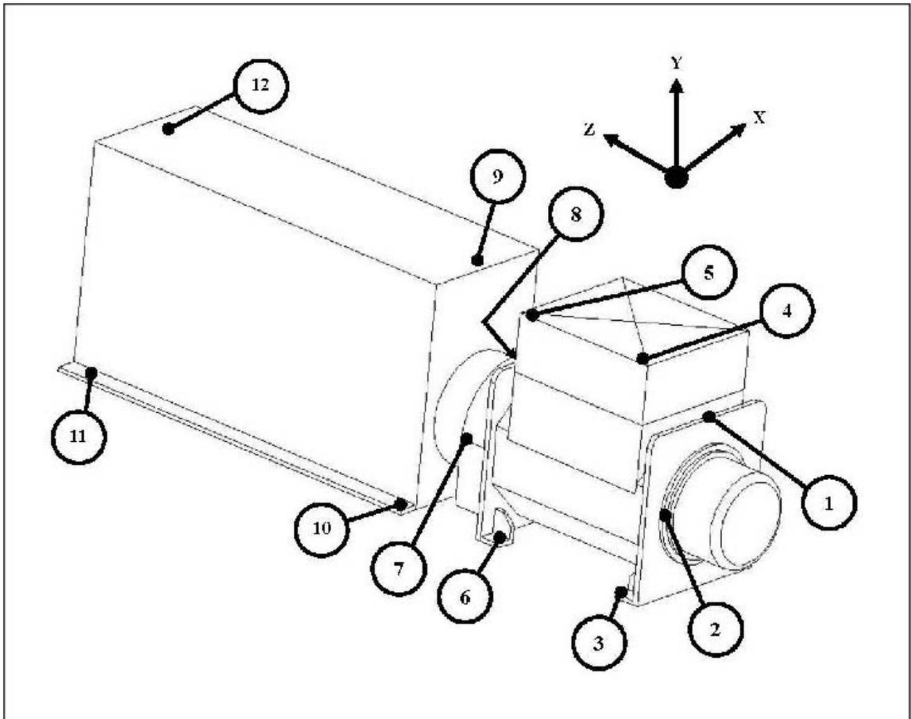
ABBILDUNG 14. POSITIONEN FÜR DIE SCHWINGUNGSMESSUNG
