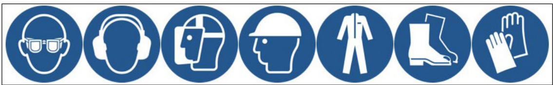
ABBILDUNG 1. MINDESTENS ERFORDERLICHE PERSÖNLICHE SCHUTZAUSRÜSTUNG (PSA)
