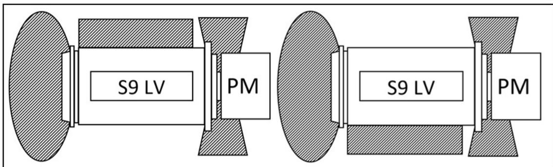
**FIGURE 5. S9 LOW VOLTAGE ALTERNATOR HAZARD ZONES**
