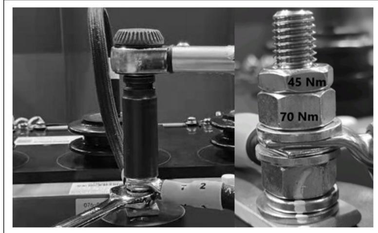
图 19. 夹紧正确的线缆（多条线缆）
