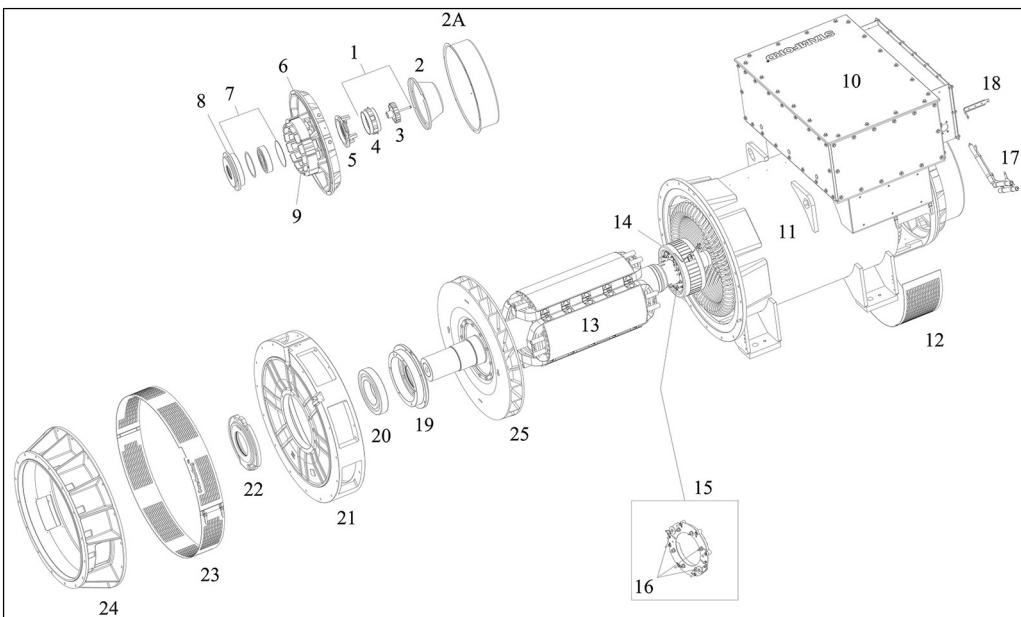
图 24. S7 高压双轴承交流发电机
