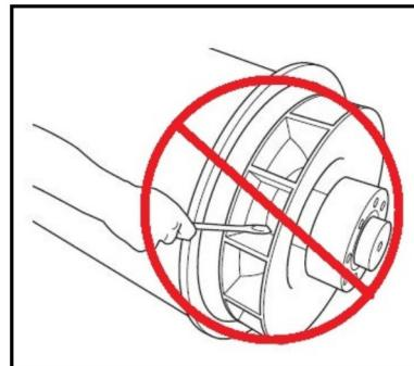
图 21. 请勿使用杆转动交流发电机转子
