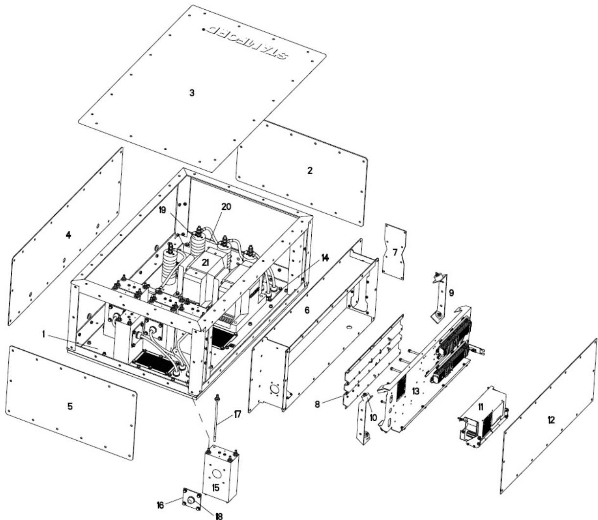
图 25. S7 高压接线盒部件和紧固件
