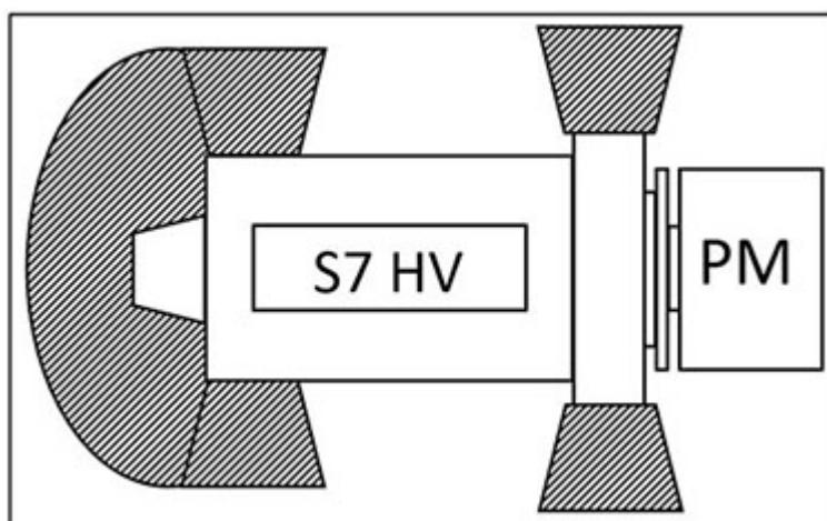
图 5. S7 高压交流发电机危险区
