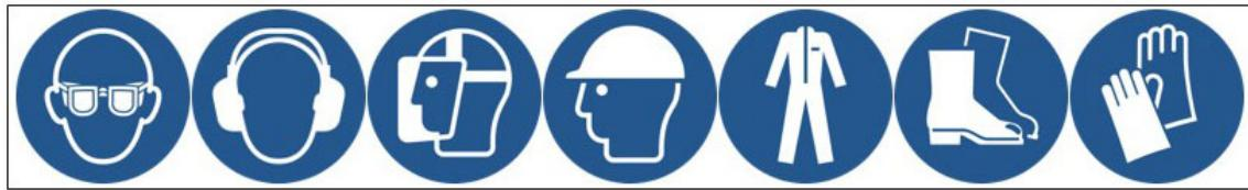
FIGURA 1. DISPOSITIVI DI PROTEZIONE INDIVIDUALE (DPI) MINIMI RACCOMANDATI
