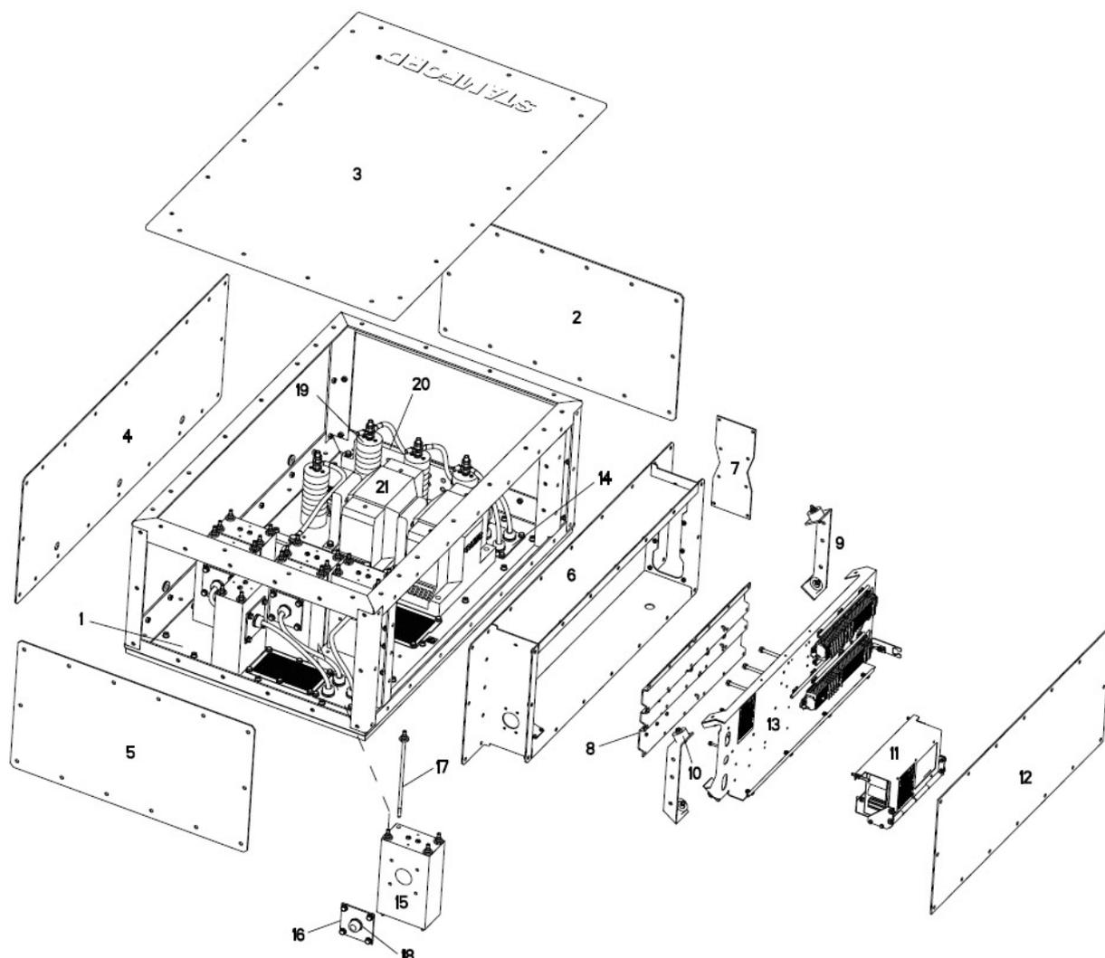
FIGURA 25. PIEZAS Y FIJADORES DE LA CAJA DE BORNES DEL S7 DE ALTA TENSIÓN
