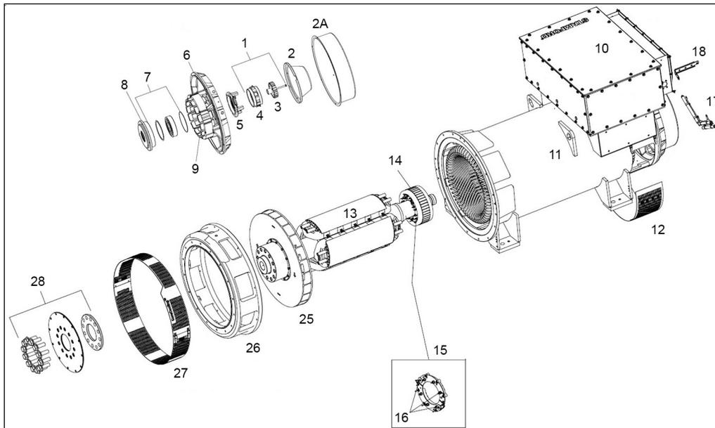
FIGURA 23. ALTERNADOR S7 DE ALTA TENSIÓN DE UN COJINETE
