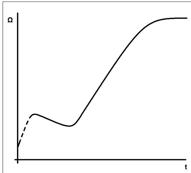
**FIGURA 22. GRÁFICO DE LA RESISTENCIA DEL AISLAMIENTO**
