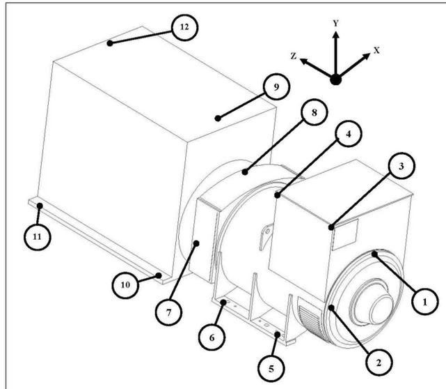
FIGURA 14. UBICACIONES DE MEDICIÓN DE LA VIBRACIÓN
