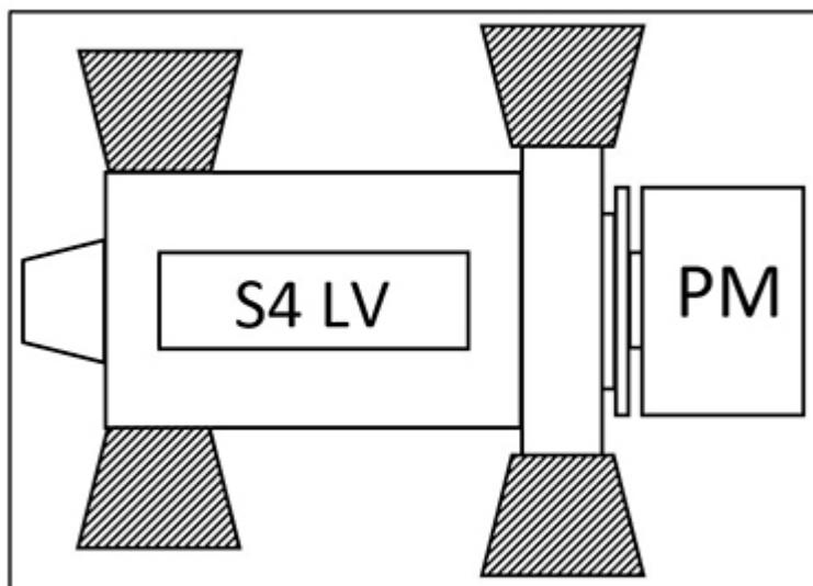
图 5. S4 低压交流发电机危险区
