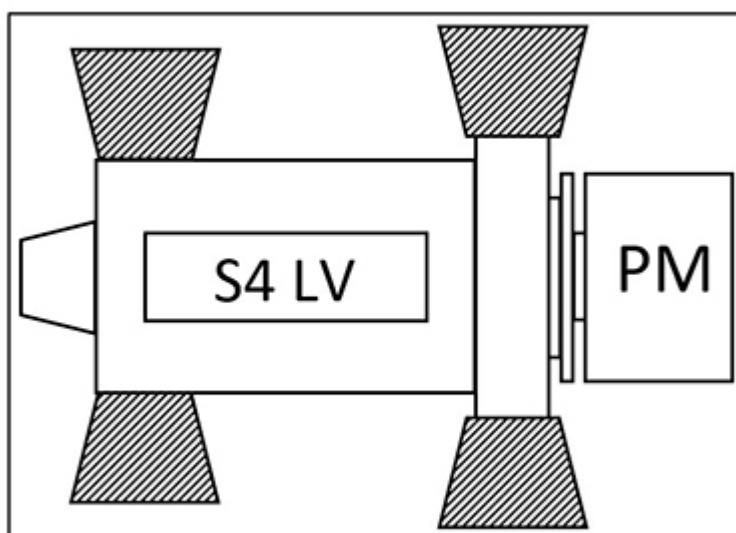
**FIGURE 5. S4 LOW VOLTAGE ALTERNATOR HAZARD ZONES**
