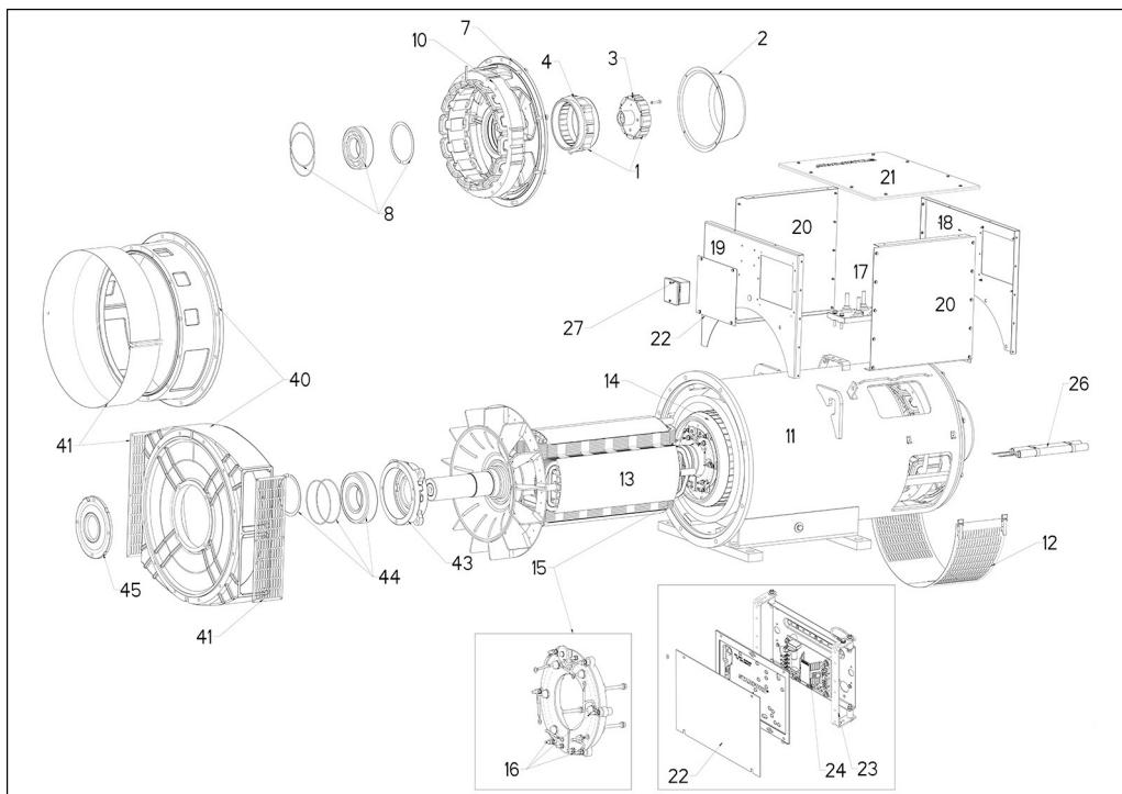
**FIGURE 29. S4 TWO BEARING ALTERNATOR**
