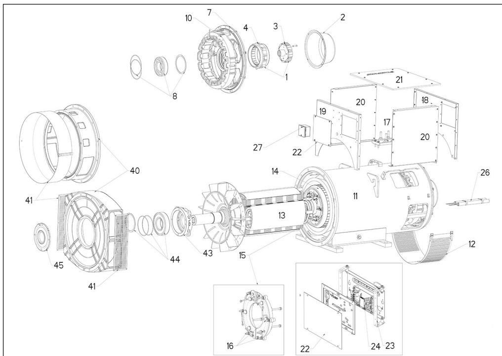
ABBILDUNG 29. S4 GENERATOR MIT ZWEI LAGERN
