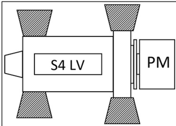
ABBILDUNG 5. GEFAHRENBEREICHE DES NIEDERSPANNUNGSGENERATORS S4
