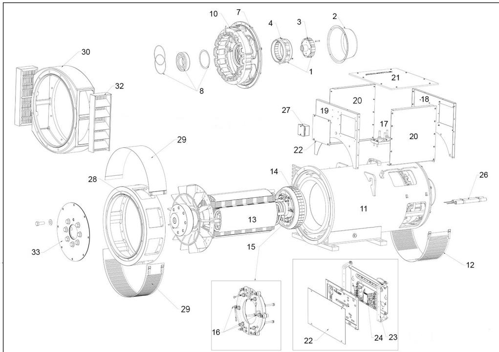
図 27. S4 1 ベアリング オルタネーター
