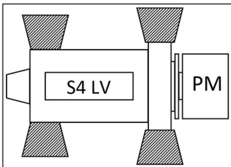
図 5. S4 低電圧オルタネーターの危険区域
