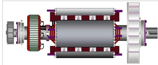
図 21. 2 ベアリング オルタネーターの回転子: 右側にフレキシブル結合用のキー溝の付いたシャフトがある
