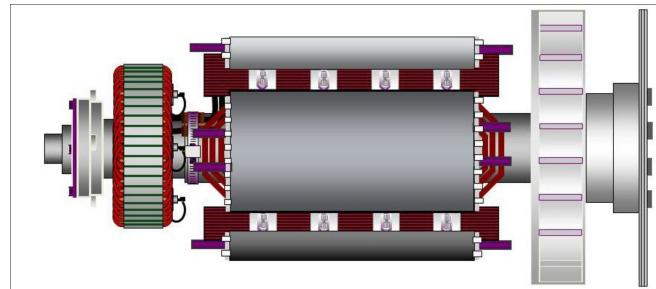
図 20. ドライブ エンド カップリング ハブにボルトで固定されたカップリング ディスクを示す右ベアリング オルタネーター ローター
