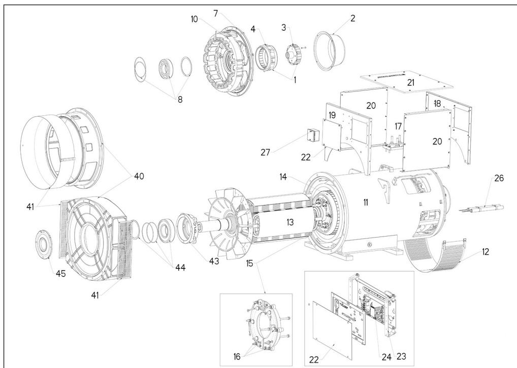
図 29. S4 2 ベアリング オルタネーター
