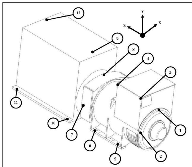
РИС. 18. МЕСТОПОЛОЖЕНИЯ ИЗМЕРЕНИЯ ВИБРАЦИИ
