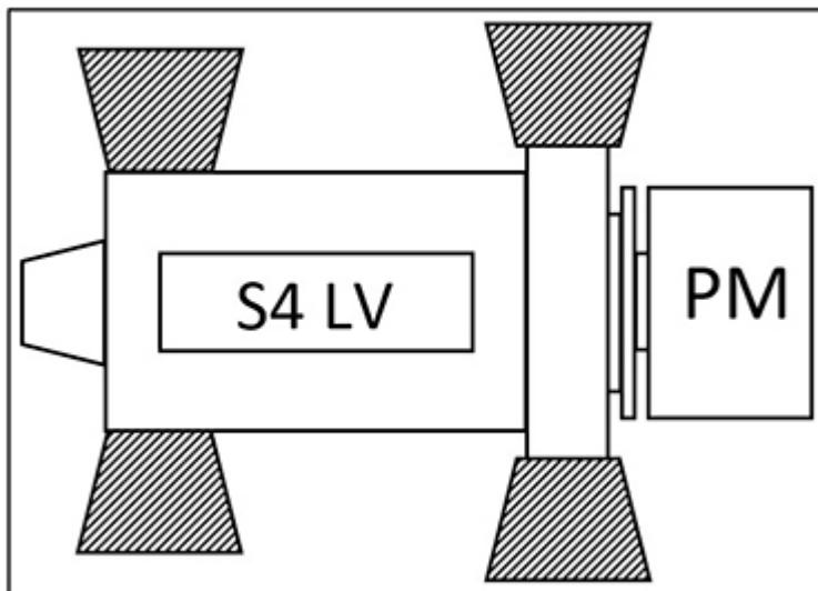
РИС. 5. ОПАСНЫЕ ЗОНЫ ГЕНЕРАТОРА НИЗКОГО НАПРЯЖЕНИЯ S4
