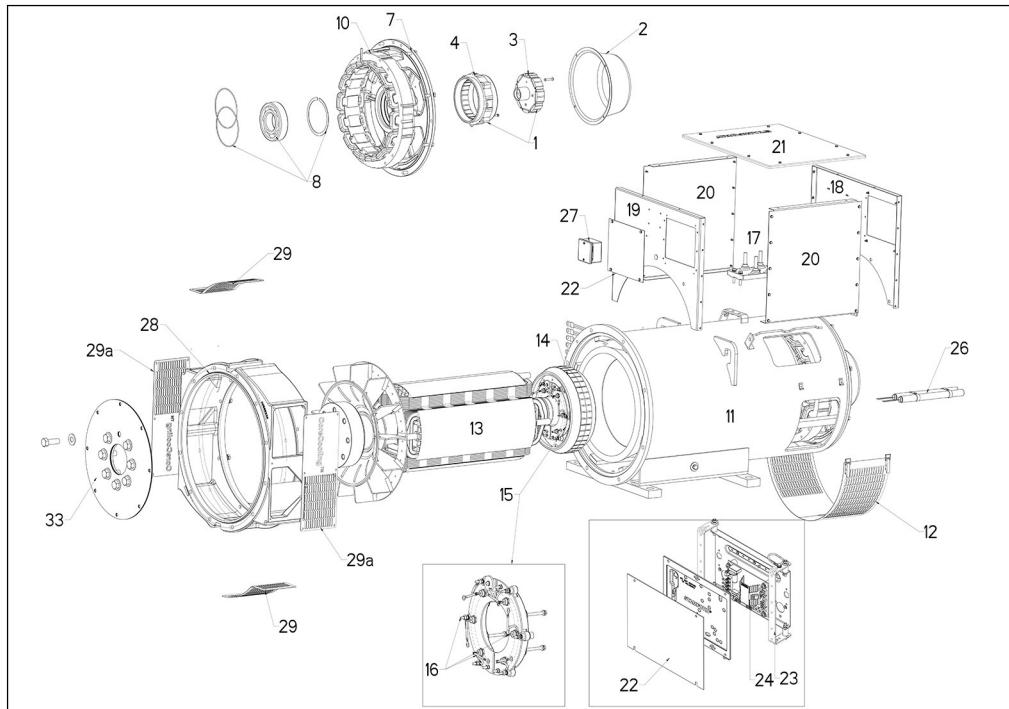
РИС. 28. ГЕНЕРАТОР S4 С ОДНИМ ПОДШИПНИКОМ (СПЕЦИАЛИЗИРОВАННЫЙ)
