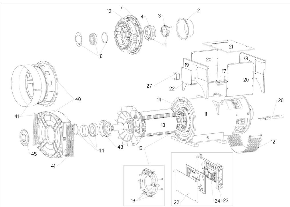
РИС. 29. ГЕНЕРАТОР С ДВУМЯ ПОДШИПНИКАМИ S4
