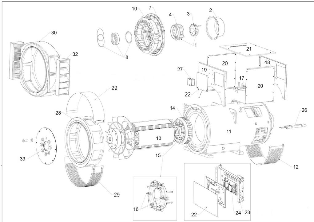
РИС. 27. ГЕНЕРАТОР S4 С ОДНИМ ПОДШИПНИКОМ
