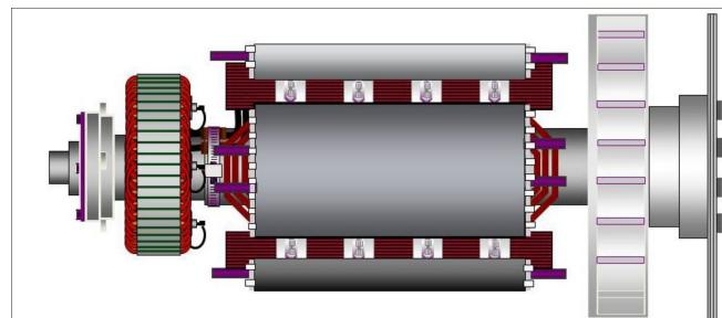
图 20. 显示用螺栓连接到右侧驱动端联轴器轮毂的耦合盘的单轴承交流发电机转子
