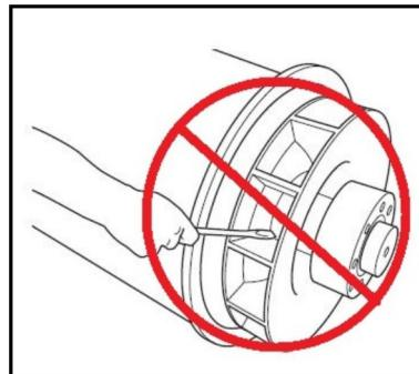
图 25. 请勿使用杆转动交流发电机转子
