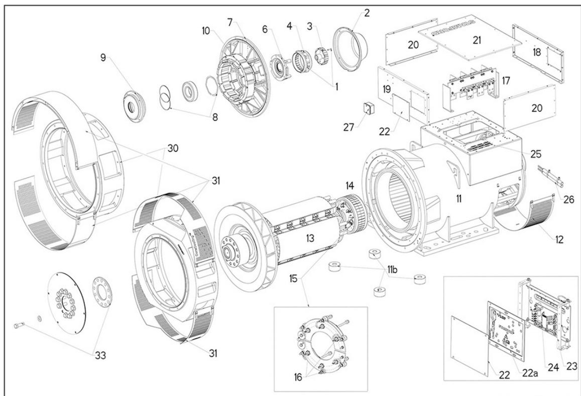
图 28. S6 单轴承交流发电机 G - H 芯
