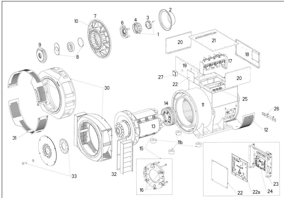
图 27. S6 单轴承交流发电机 C - F 芯
