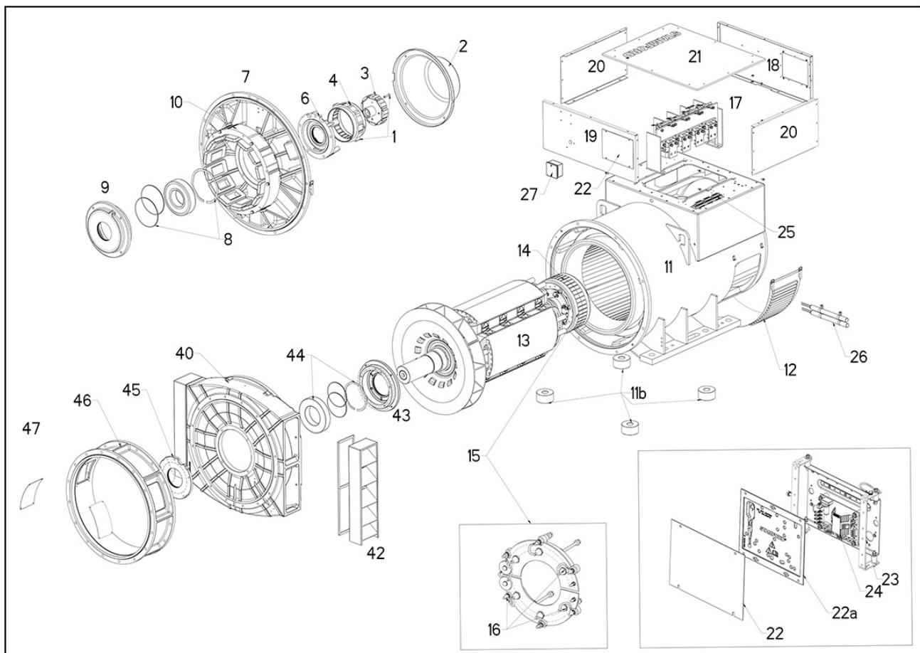
图 30. S6 双轴承交流发电机 C - F 芯
