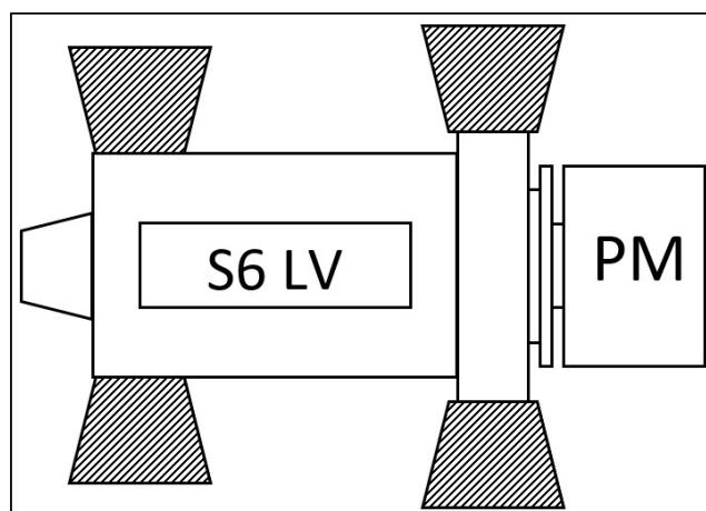
图 5. S6 低压交流发电机危险区
