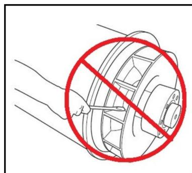
图 19. 请勿使用杆转动交流发电机转子
