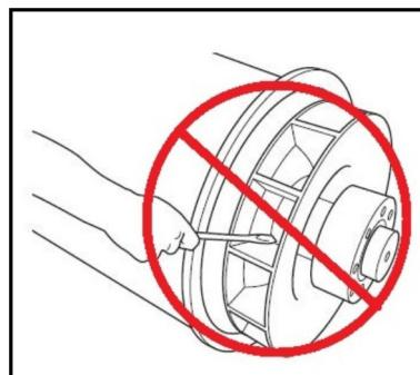
ABBILDUNG 25. DEN GENERATORROTOR NICHT MIT EINEM HEBEL DREHEN
