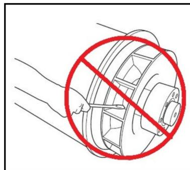
**ABBILDUNG 19. DEN GENERATORLÄUFER NICHT MIT EINEM HEBEL DREHEN**
