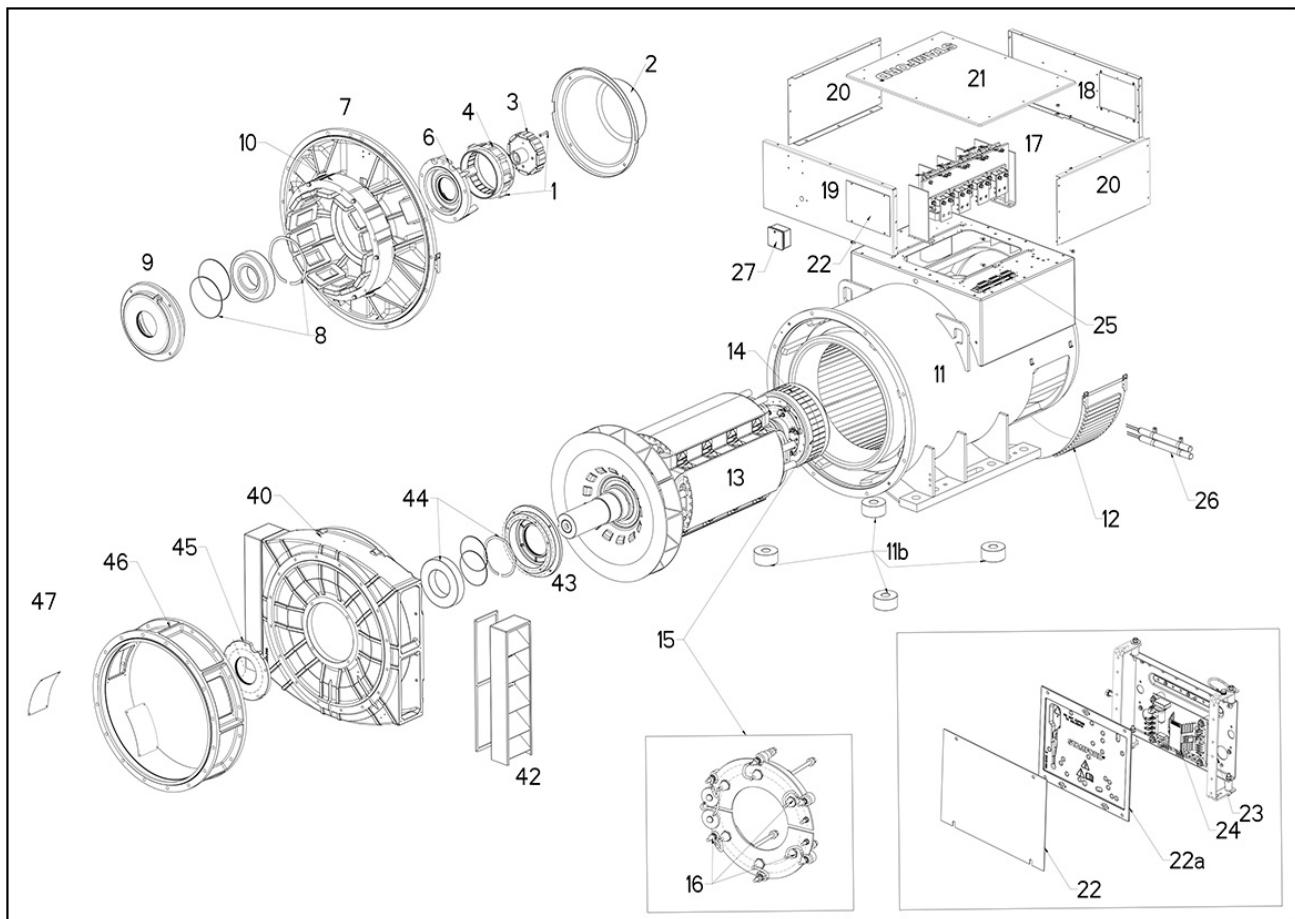
ABBILDUNG 30. S6 GENERATOR MIT 2 LAGER KERNE C BIS F
