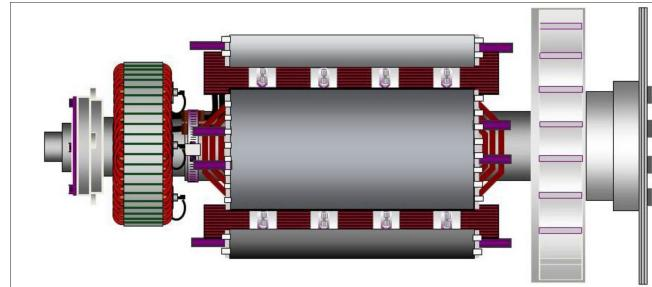
ABBILDUNG 20. ONE BEARING ALTERNATOR ROTOR SHOWING COUPLING DISCS BOLTED TO DRIVE END COUPLING HUB AT RIGHT
