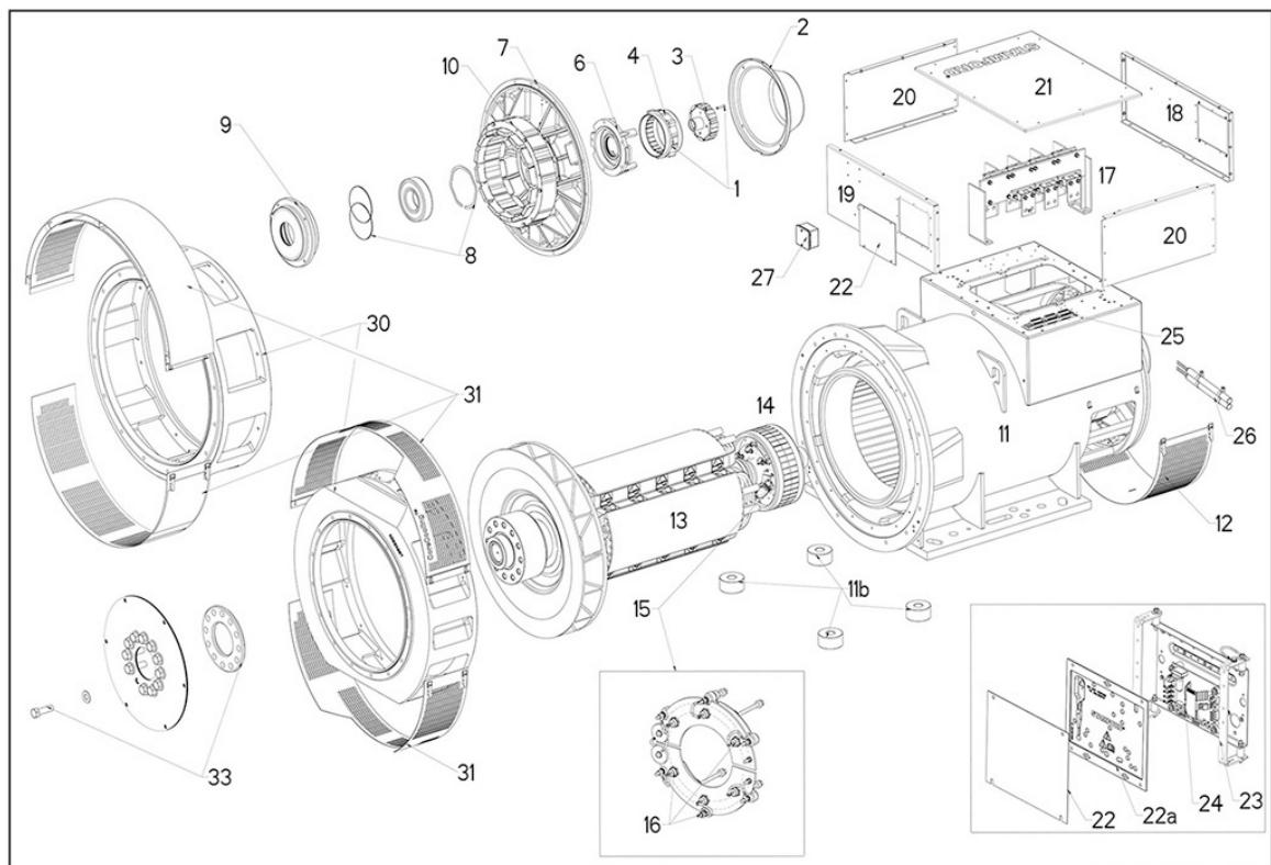
ABBILDUNG 28. S6 GENERATOR MIT 1 LAGER KERNE G BIS H
