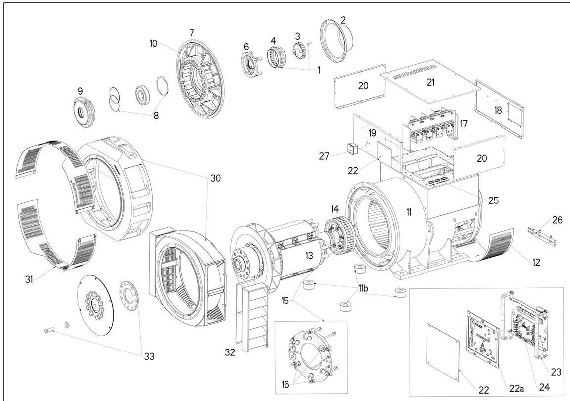
FIGURA 27. ALTERNADOR S6 COM UM ROLAMENTO (NÚCLEO C-F)
