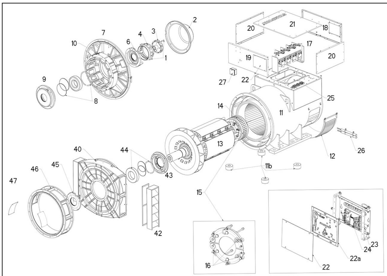
FIGURA 30. ALTERNADOR S6 COM DOIS ROLAMENTOS (NÚCLEO C-F)
