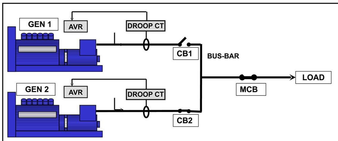
FIGURA 24. COLOCAÇÃO EM PARALELO OU SINCRONIZAÇÃO DE ALTERNADORES
