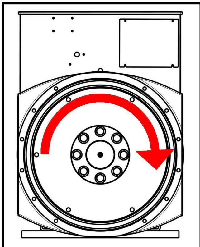
FIGURA 23. DIREÇÃO DE ROTAÇÃO
