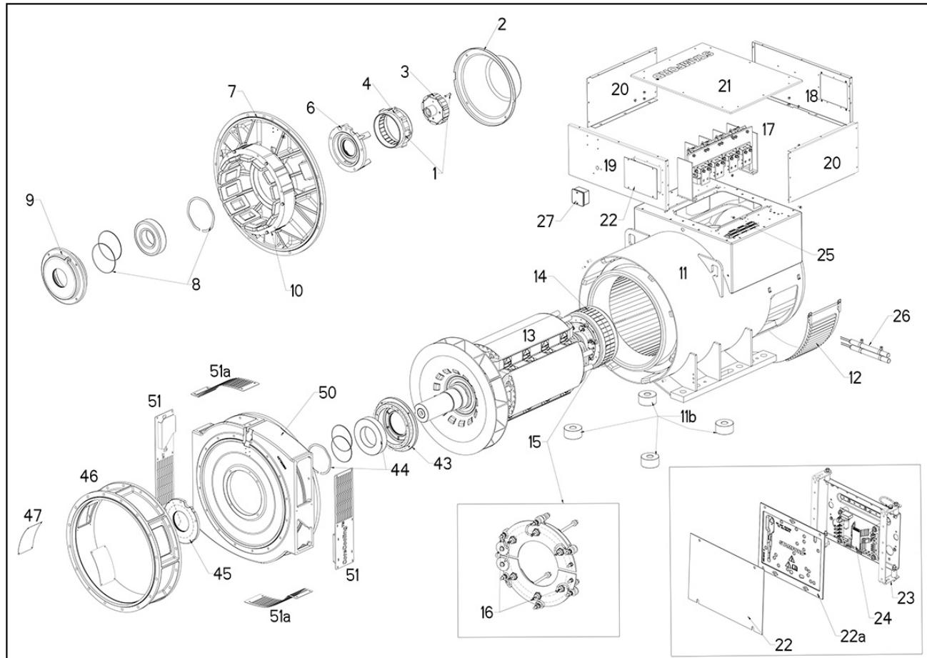
FIGURA 31. ALTERNADOR S6 DEDICADO COM DOIS ROLAMENTOS (NÚCLEO C-F)
