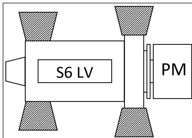
**FIGURA 5. ZONAS DE PERIGO DO ALTERNADOR S6 DE BAIXA TENSÃO**
