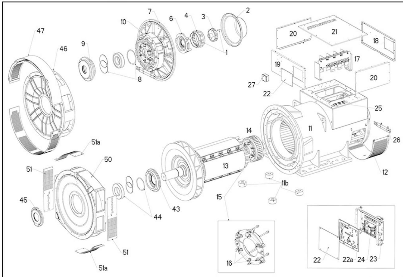
FIGURA 32. ALTERNADOR S6 DEDICADO COM DOIS ROLAMENTOS (NÚCLEO G-H)
