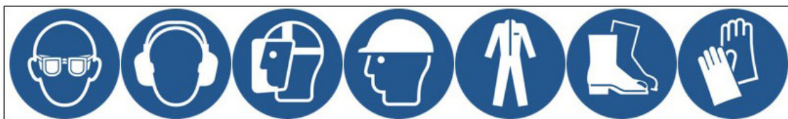
FIGURE 1. ÉQUIPEMENT DE PROTECTION PERSONNELLE (PPE) MINIMUM RECOMMANDÉ
