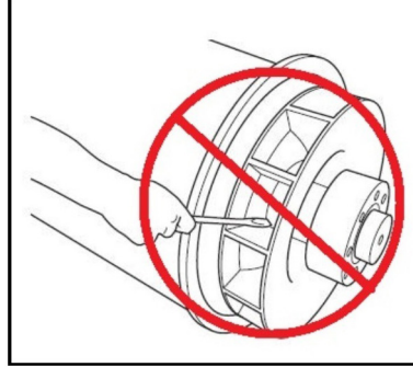
الشكل 25. لا تقم بتدوير العضو الدوار لمولد التيار المتردد بواسطة رافعة
