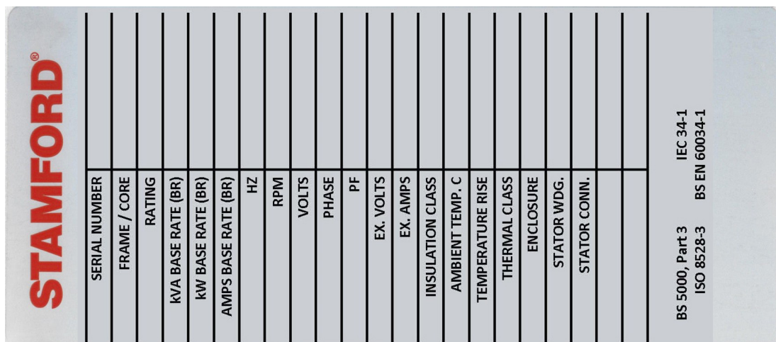
ABBILDUNG 14. ALLGEMEINES TYPENSCHILD FÜR STAMFORD-WECHSELSTROMGENERATOREN
