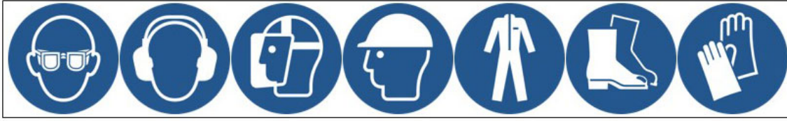
الشكل 1. الحد الأدنى الموصى به من معدات الحماية الشخصية (PPE)
