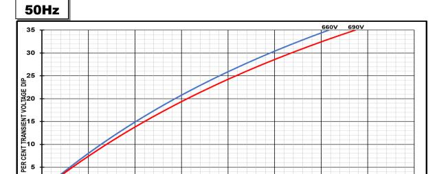
4000 5000 LOCKED ROTOR KVA
