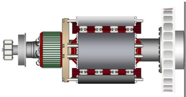
FIGURA 15. ROTOR DE ALTERNADOR DE UN COJINETE EN EL QUE SE MUESTRAN LOS DISCOS DE ACOPLAMIENTO ATORNILLADOS AL CUBO DEL ACOPLAMIENTO DEL EXTREMO IMPULSOR (A LA DERECHA)
