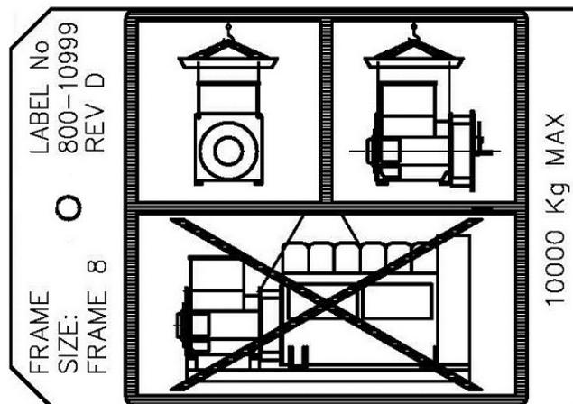
FIGURA 13. ETIQUETA DE ELEVACIÓN
