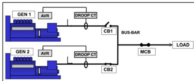
**FIGURA 22. ALTERNADORES PARALELOS O DE SINCRONIZACIÓN**
