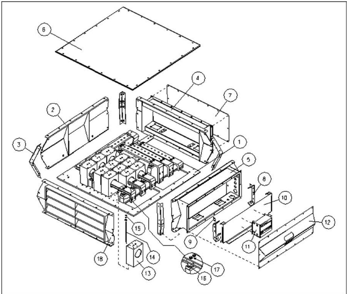
FIGURA 27. CAJA DE BORNES DE LV
