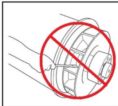
**FIGURA 14. NO ROTAR CON UNA PALANCA**
