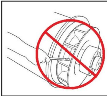
**ABBILDUNG 16. NICHT MIT EINEN HEBEL DREHEN**
