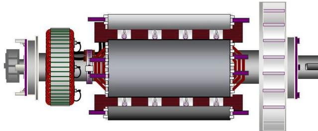
ABBILDUNG 18. ROTOR EINES ZWEILAGER-WECHSELSTROMGENERATORS, WELLE MIT PASSFEDERNUT ZUR ELASTISCHEN KUPPLUNG (RECHTS)
