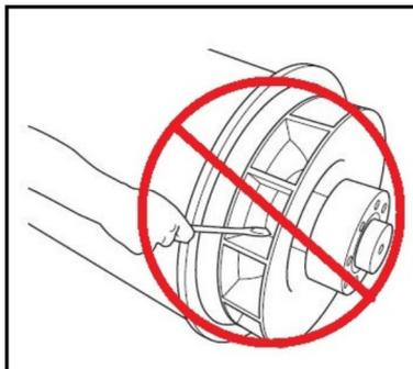
**ABBILDUNG 21. DEN GENERATORROTOR NICHT MIT EINEM HEBEL DREHEN**
