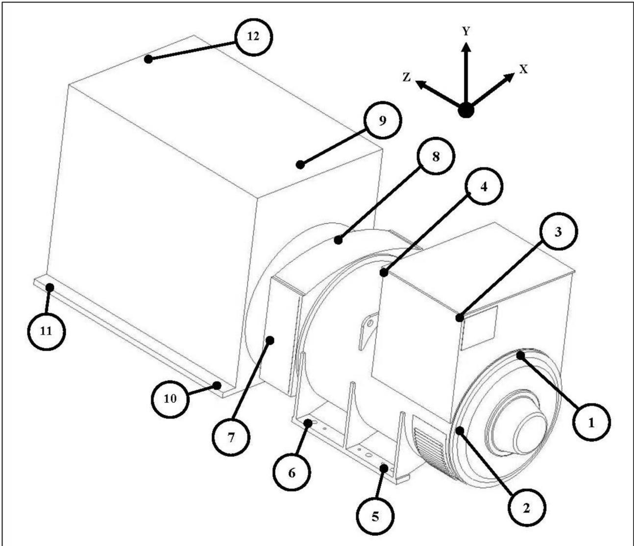
ABBILDUNG 14. POSITIONEN FÜR DIE SCHWINGUNGSMESSUNG
