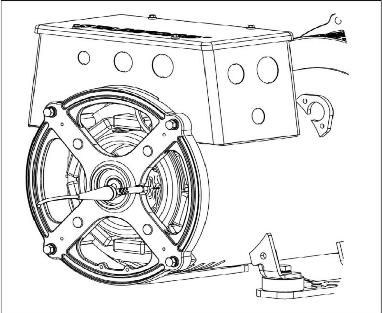
**ABBILDUNG 25. ENTFERNEN VON DIODENLÖTZINN**
