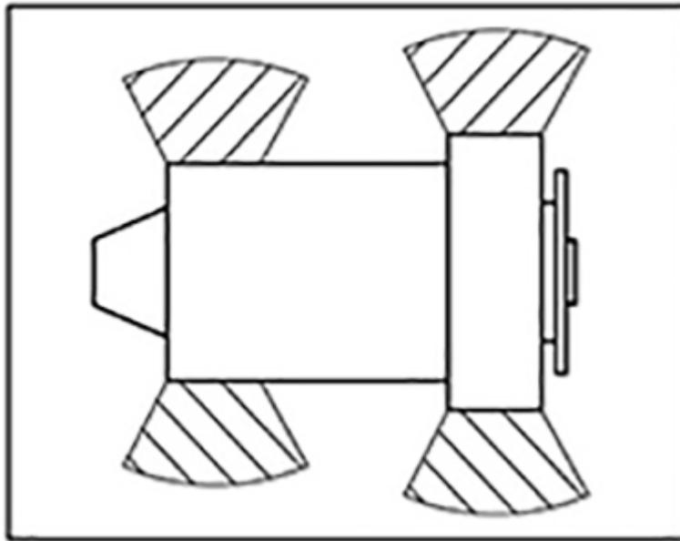
ABBILDUNG 5. GEFAHRENBEREICHE GENERATOR S0/S1
