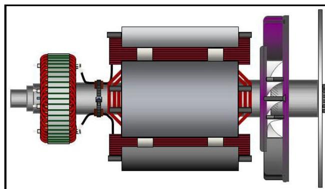
**ABBILDUNG 20. LÄUFER EINES EINZELLAGER-WECHSELSTROMGENERATORS, KUPPLUNGSSCHEIBEN MIT DER ANTRIEBSSEITIGEN KUPPLUNGSNABE VERSCHRAUBT (RECHTS)**
