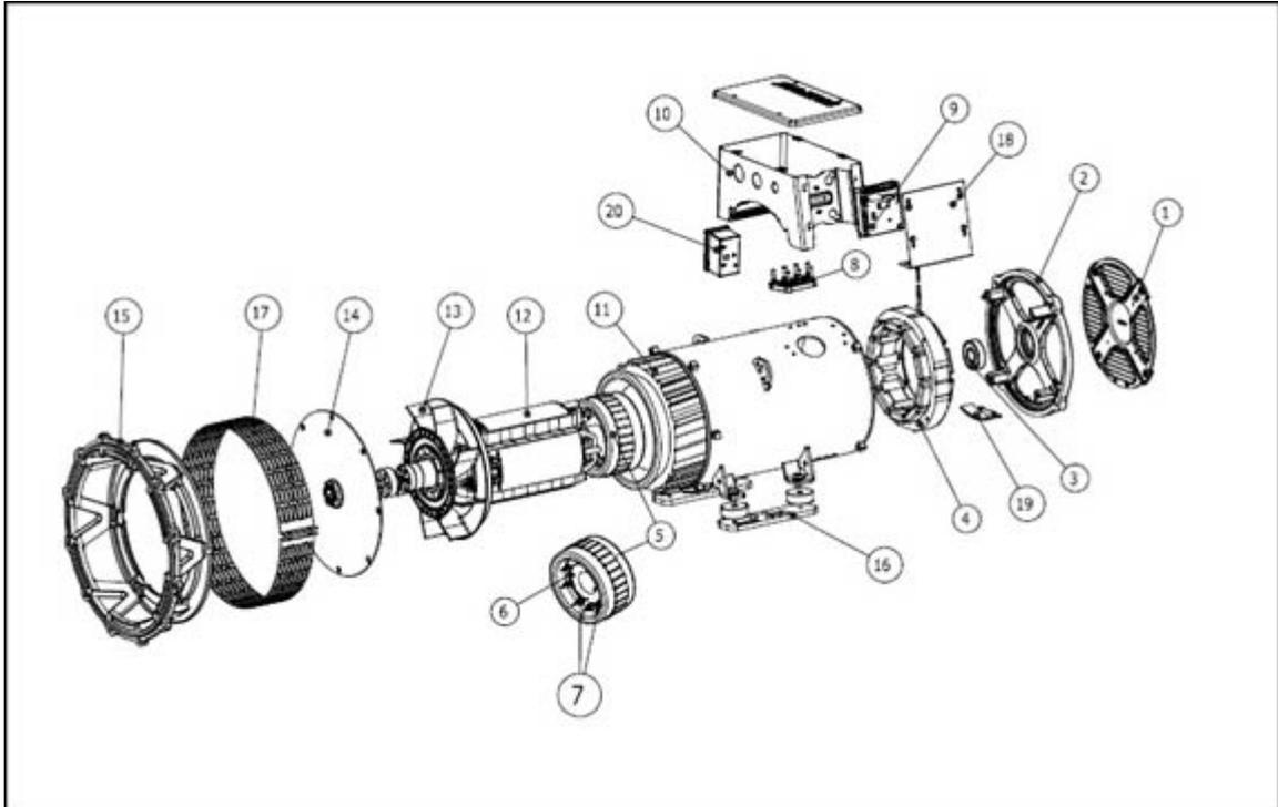
ABBILDUNG 27. EINZELLAGER GENERATOR S0/S1
