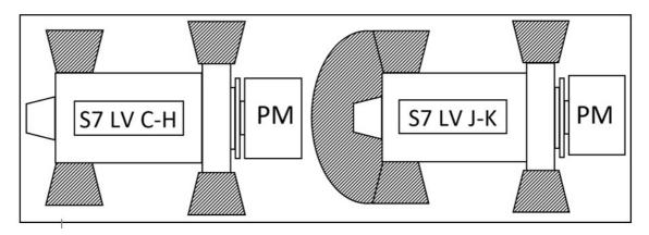
FIGURE 5. S7 LOW VOLTAGE ALTERNATOR HAZARD ZONES
