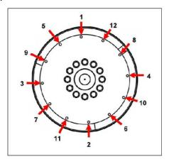
FIGURE 22. FIXING SEQUENCE
