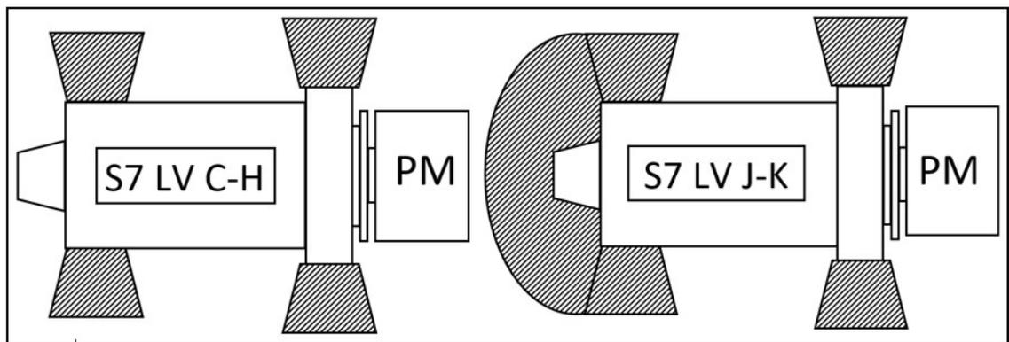
図 5. 2S7 低電圧オルタネーターの危険区域
