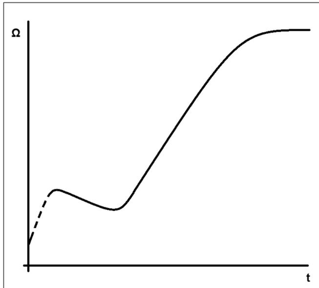
**FIGURA 25. GRÁFICO DE RESISTÊNCIA DE ISOLAMENTO**
