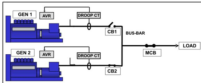
**FIGURA 23. COLOCAÇÃO EM PARALELO OU SINCRONIZAÇÃO DE ALTERNADORES**
