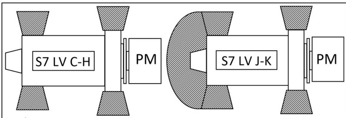
**FIGURA 5. ZONAS DE PERIGO DO ALTERNADOR S7 DE BAIXA TENSÃO**
