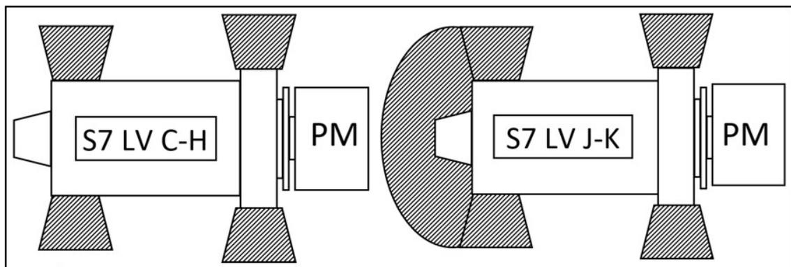
**FIGURA 5. ZONAS DE PELIGRO DEL ALTERNADOR DE BAJO VOLTAJE S7**
