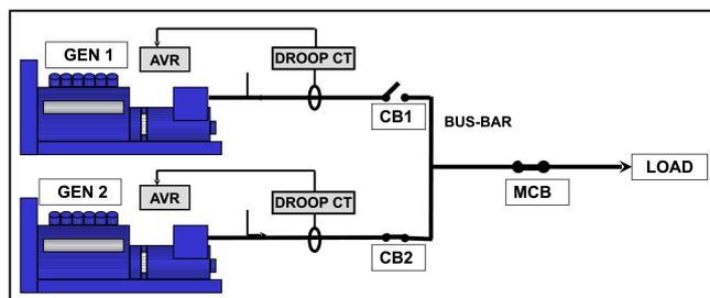
FIGURA 23. ALTERNADORES PARALELOS O DE SINCRONIZACIÓN
