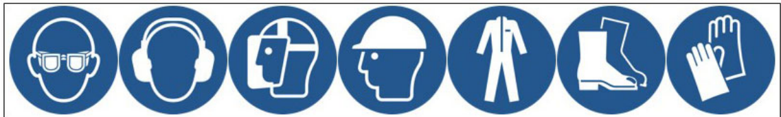
FIGURE 1. ÉQUIPEMENT DE PROTECTION PERSONNELLE (PPE) MINIMUM RECOMMANDÉ
