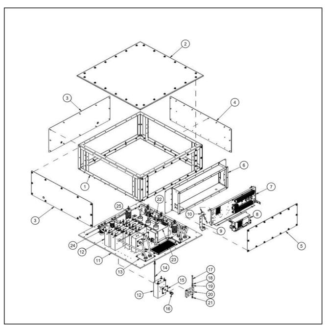
FIGURE 28. MEDIUM AND HIGH VOLTAGE TERMINAL BOX PARTS AND FASTENERS
