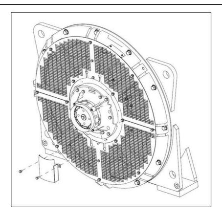
FIGURE 23. GREASE TRAP S9
