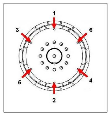
FIGURE 19. FIXING SEQUENCE TO FLYWHEEL
