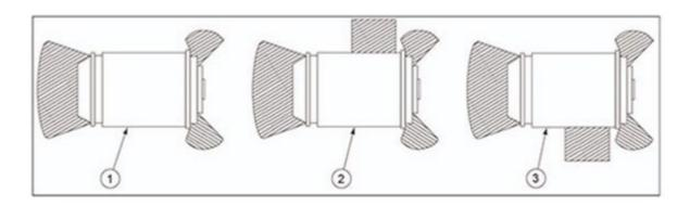
FIGURE 5. S9 ALTERNATOR HAZARD ZONES
