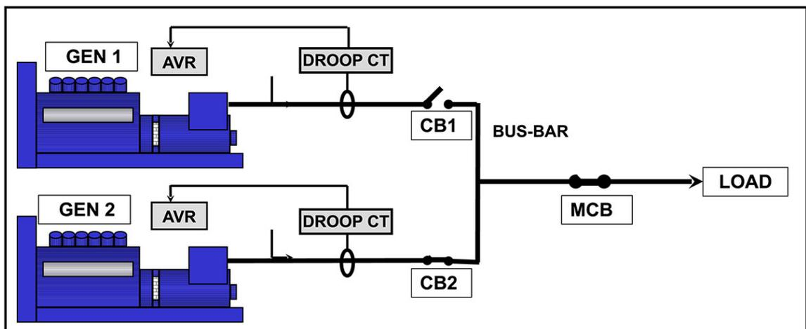
FIGURA 22. ALTERNADORES PARALELOS O DE SINCRONIZACIÓN
