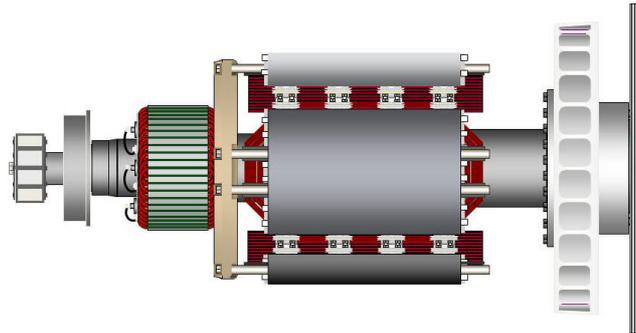
**FIGURA 16. ROTOR DEL ALTERNADOR DE UN COJINETE EN EL QUE SE OBSERVAN LOS DISCOS DE ACOPLAMIENTO ATORNILLADOS AL CUBO DE ACOPLAMIENTO DEL EXTREMO IMPULSOR (A LA DERECHA)**
