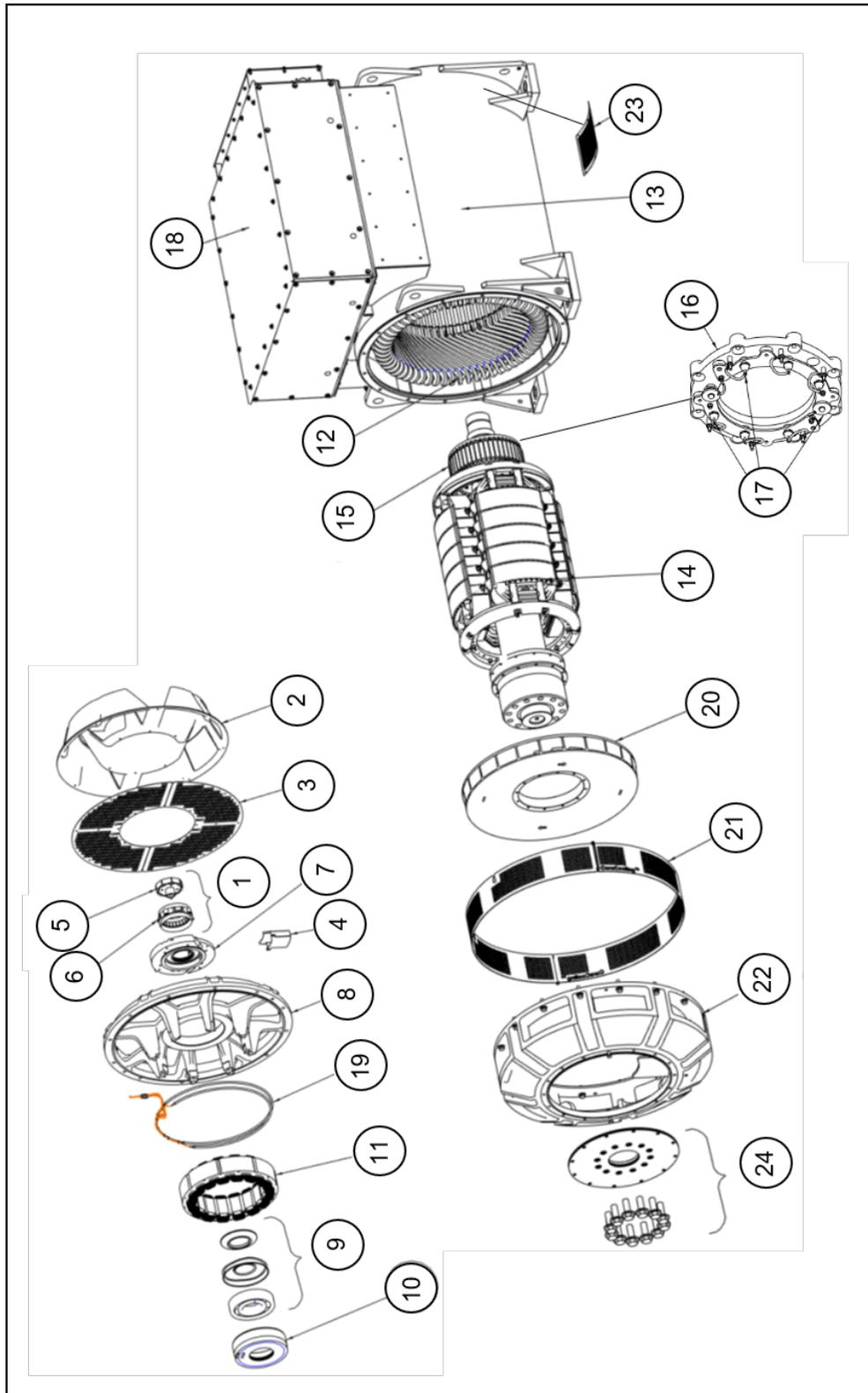
FIGURA 26. ALTERNADOR DE UN COJINETE S9
