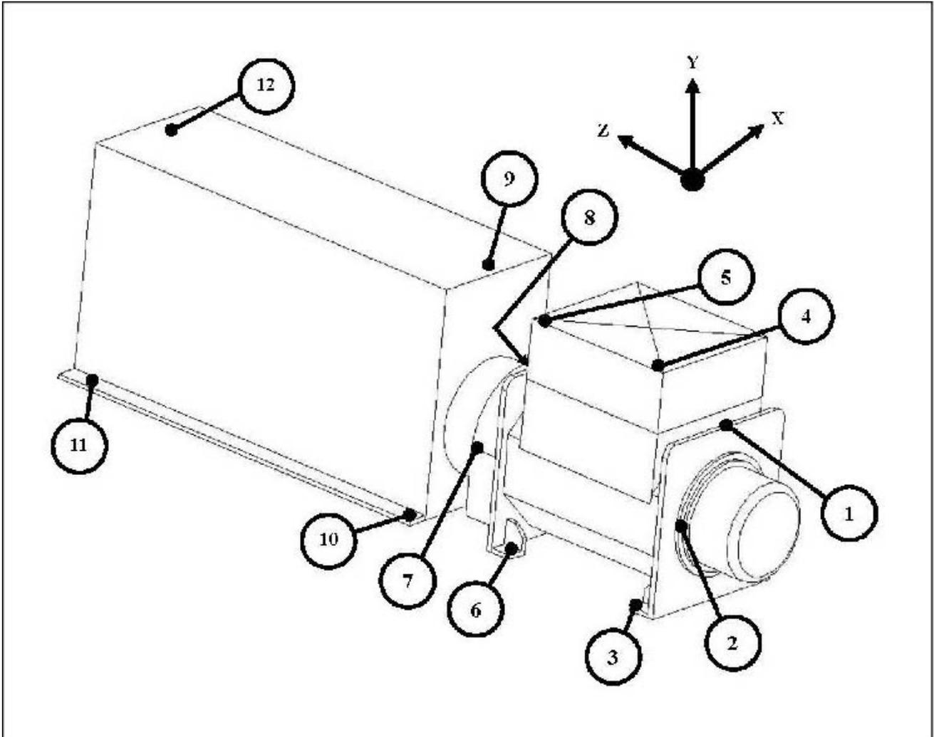
FIGURA 14. POSICIONES DE MEDICIÓN DE LA VIBRACIÓN
