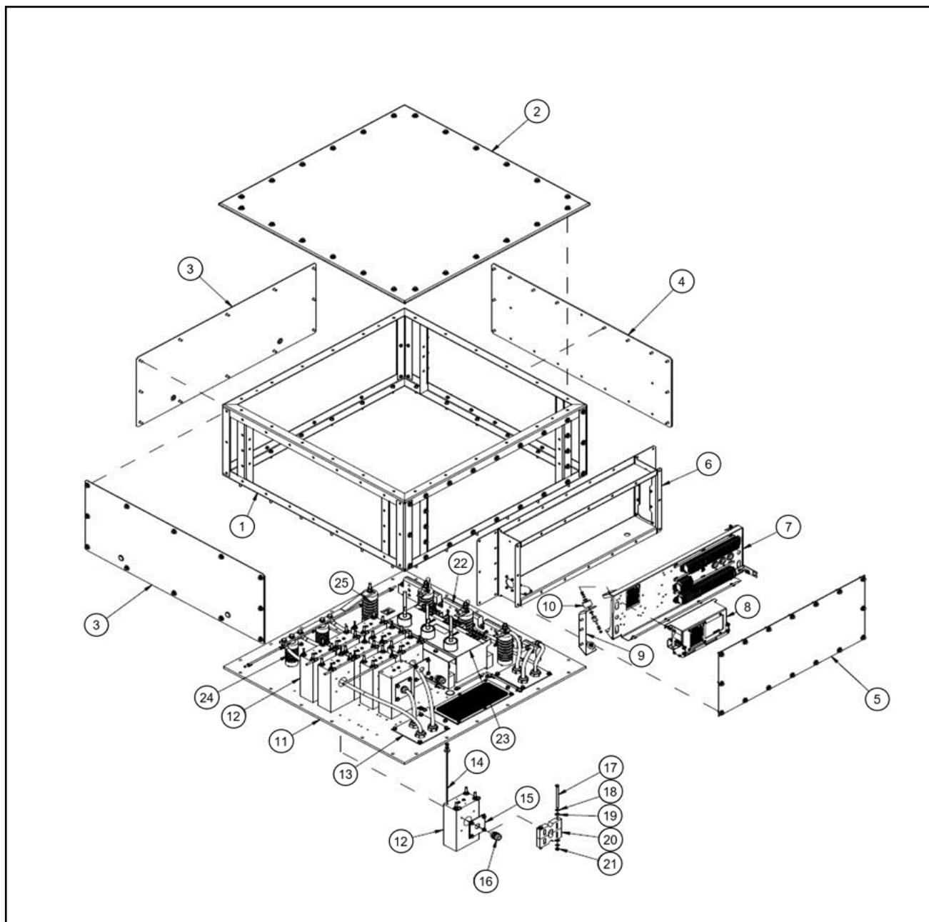
FIGURA 28. PIEZAS Y FIJADORES DE LA CAJA DE BORNES DE VOLTAJE BAJO Y MEDIO
