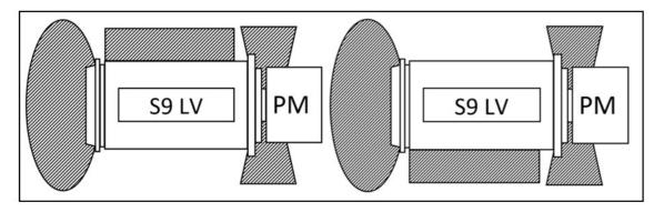
FIGURE 5. S9 LOW VOLTAGE ALTERNATOR HAZARD ZONES
