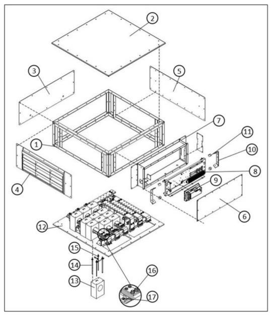
FIGURE 32. S9 LOW VOLTAGE TERMINAL BOX
