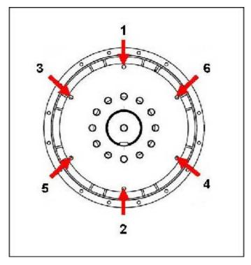
FIGURE 23. FIXING SEQUENCE TO FLYWHEEL
