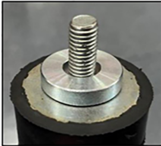
图 8. 将平垫圈安装到防振支架的顶部
