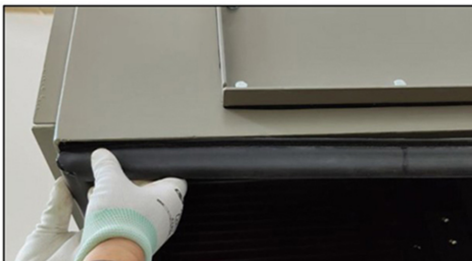
RYSUNEK 11. ZAMONTOWANA USZCZELKA
