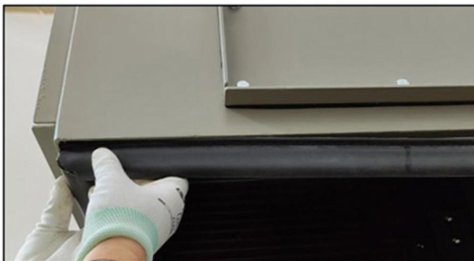
**FIGURA 11. JUNTA INSTALADA**
