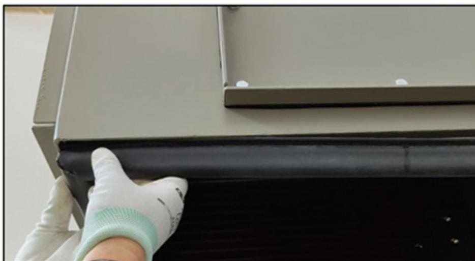
**FIGURA 11. JUNTA MONTADA**
